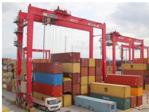
Rys. 2. Suwnica bramowa na placu przeładunkowo-składowym obsługująca samochód ciężarowy. Źródło: [9]
