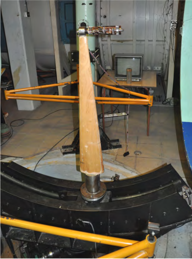
Rys. 5. Widok ogólny stanowiska przygotowanego do badań wagowych (z zamontowanym masztem i wagą tensometryczną)
