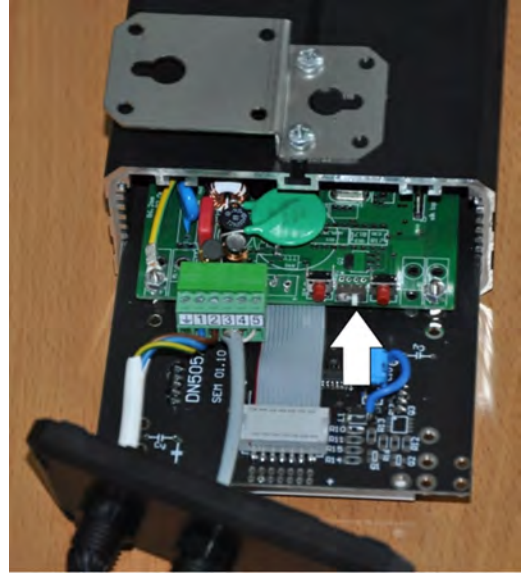
Rys. 7. Przyciski służące do sprzętowej zmiany opcji wyświetlania (zaznaczone białą strzałką)
