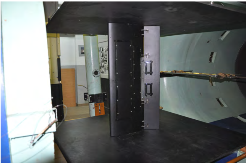
Rys. 3. Model profilu ze sterowaną klapą, przeznaczony do badań ciśnieniowych w tunelu T-1
