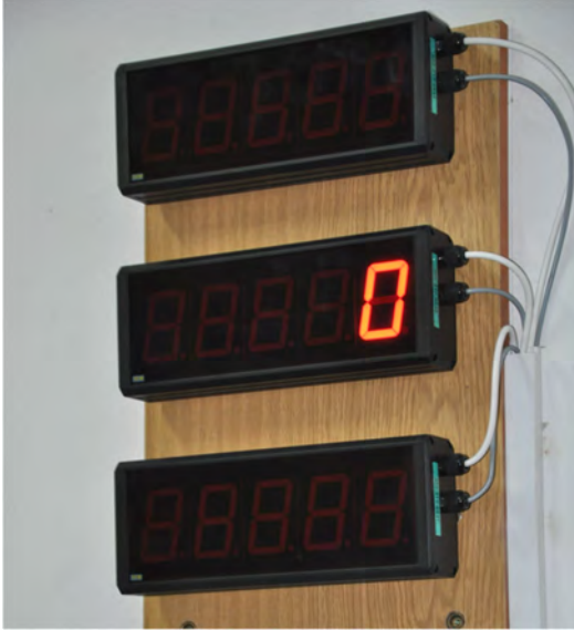
Rys. 6. Zestaw trzech wyświetlaczy: kąta natarcia, kąta ślizgu i ciśnienia dynamicznego
