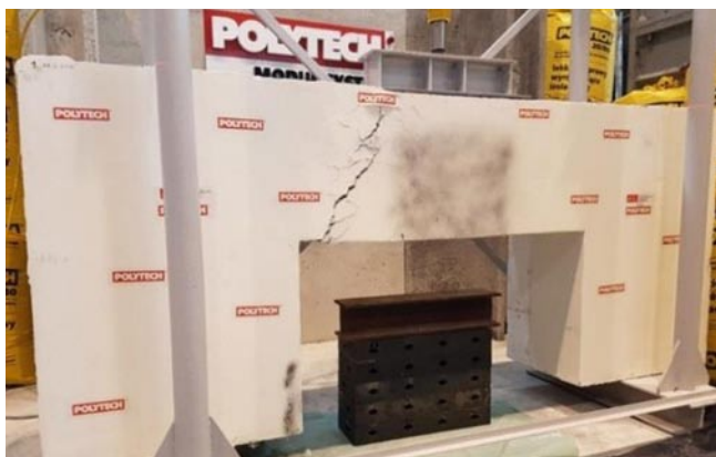
Rys. 11. Badany element po zniszczeniu w rezultacie przyłożenia obciążenia
