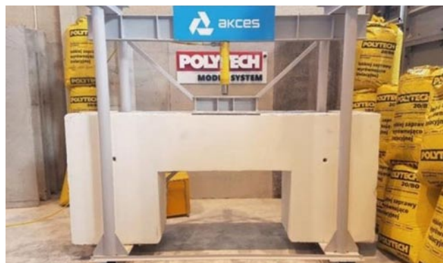
Rys. 5. Obiekt badań na stanowisku badawczo-pomiarowym (urządzenie ściskające)
