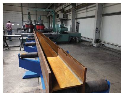
Rys. 3. Prosty element przed gięciem
