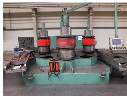
Rys. 2. Maszyna użyta do gięcia elementu badawczego
