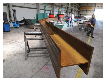
Rys. 4. Element badawczy po wygięciu
