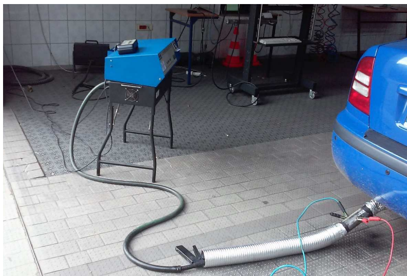
Rys. 2. Przebieg pomiaru zadymienia spalin z użyciem filtra elektrycznego Źródło: Opracowanie własne
