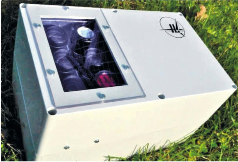
Rys. 1. Zdjęcie kamery wielospektralnej zbudowanej w Instytucie Lotnictwa [Kotlarz, 2014]
