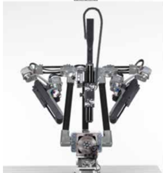
Rysunek 6. Projekt i prototyp mechatronicznej platformy 2+1 (2 narzędzia + optyka toru wizyjnego). To stałopunktowy robot chirurgiczny o zwiększonej sztywności pracy przeznaczony do manewrowania/trzymania toru wizyjnego wraz z co najmniej jednym narzędziem z możliwością wstępnego ustawienia punktów pracy dla wymienionych instrumentów chirurgicznych mocowanych na pojedynczym ramieniu robota. Robot ten charakteryzuje się możliwością wstępnego ustawienia w polu operacyjnym niezależnie od siebie narzędzi znajdujących się na jego ramieniu jak i samego robota względem stołu [10]
