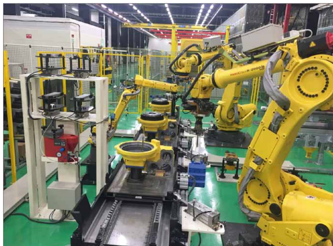
Rys. 1. Montaż przekładni robotów w fabryce FANUC
