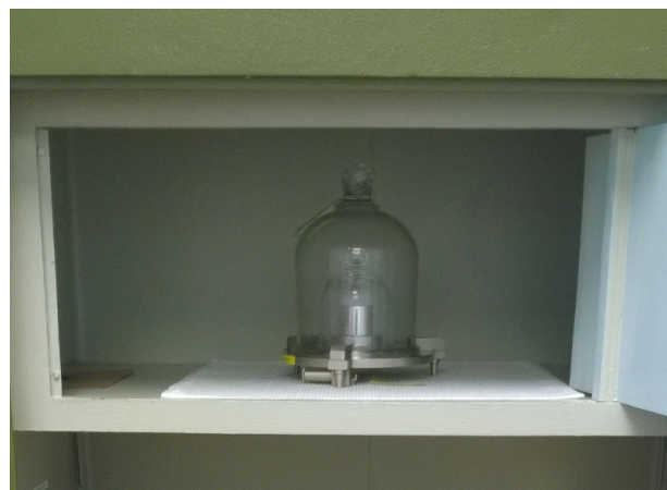
Rys. 3. Sposób przechowywania prototypu nr 51 w GUM
