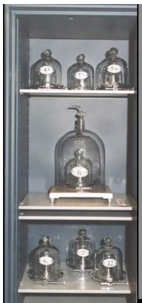
Rys. 1. Sposób przechowywania IPK oraz jego sześciu kopii w BIPM fot.: www.bipm.org
