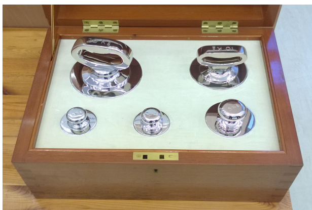
Rys. 5. Sposób przechowywania oraz przenoszenia wzorców odniesienia
