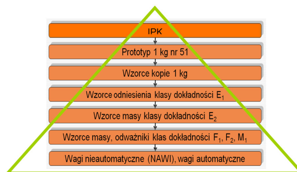
Rys. 4. Uproszczony schemat hierarchicznego układu sprawdzian w GUM
