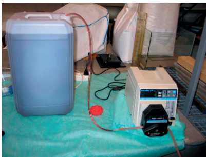
Fot. 2. Pompa perystaltyczna Masterflex wraz ze zbiornikiem dozowanego oleju opałowego
