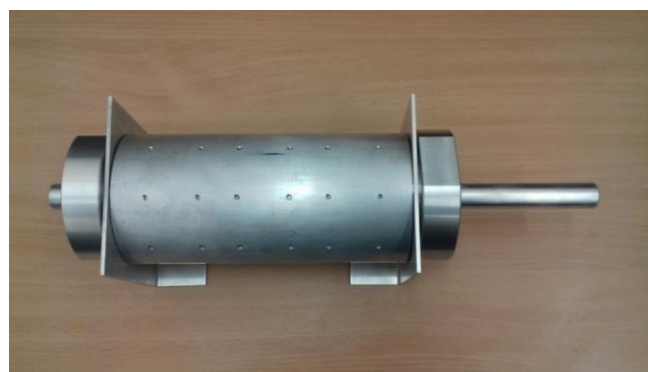
Rys. 2. Widok prototypu tłumika magnetoreologicznego TMR-001
