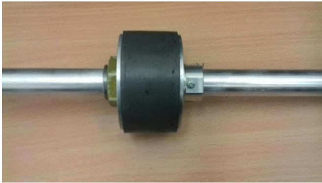
Rys. 3. Widok założonego elastomeru magnetoreologicznego na tloczynko
