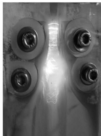
Rysunek 3.2b. Zdjęcie plazmy powstającej w reaktorze Gliding Arc [53].
