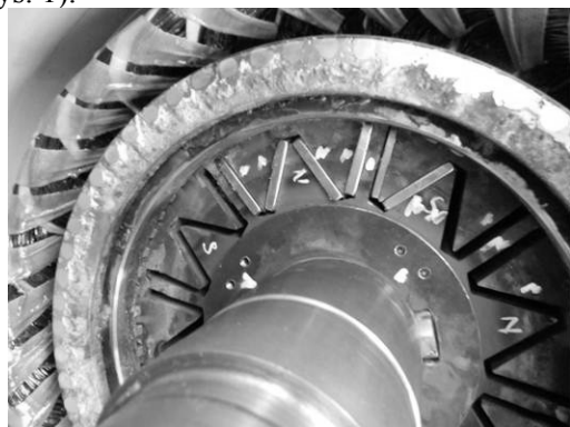
Rys. 1 Widok wirnika z magnesami trwałymi
