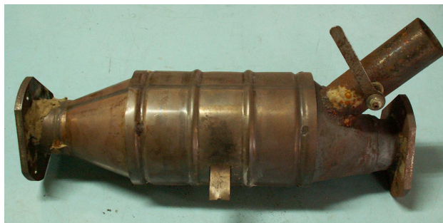
Rys. 2. Reaktor katalityczny z mimośrodowym stożkiem, z kołnierzami przyłączeniowymi i króćcem do zamontowania grzałki elektrycznej. (reaktor platynowo-palladowy Pt/Pd – o ładunku: 1g/dm 3 w stosunku Pt:Pd/2:1, ilość kanalików: 500 cpsi)
