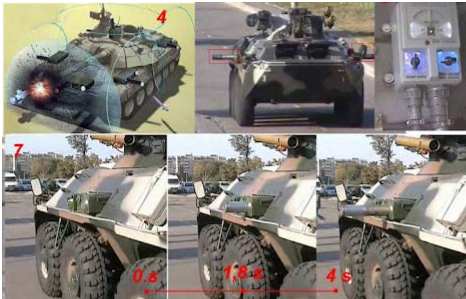
Rys. 2. Schemat działania systemu Zaslon wraz z widokiem przygotowania modułów ochronnych do pracy bojowej (fot. Immersion Hi Tech LTD) [3]
