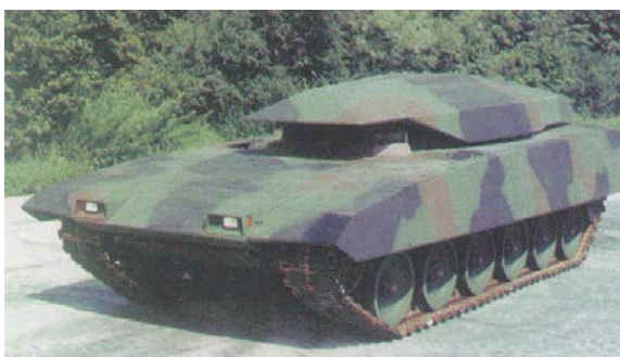
Rys. 10. Pojazd wykonany na bazie czołgu Leopard 2 w technologii obniżonej wykrywalności EGS (fot. Krauss-Maffei). [3]
