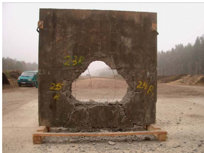
Rys. 9. Efekt penetracji trzema 120 mm pociskami typu MP-PELE podwójnie zbrojonej płyty żelbetowej o grubości 200 mm (fot. Rheinmetall) [2]
