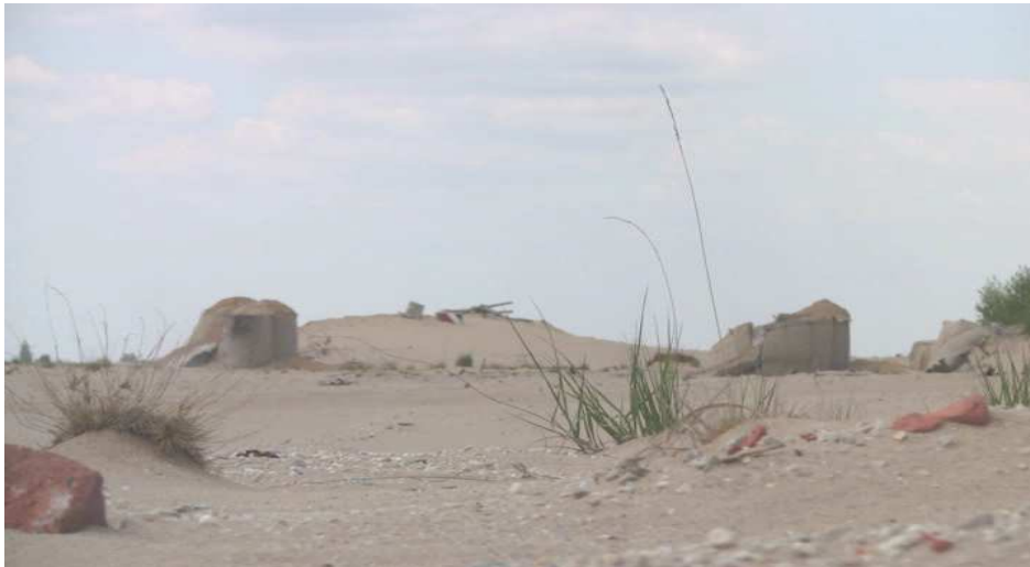
Fot. 6. Fragmenty umocnień po trafieniu każdego jednym pociskiem.
