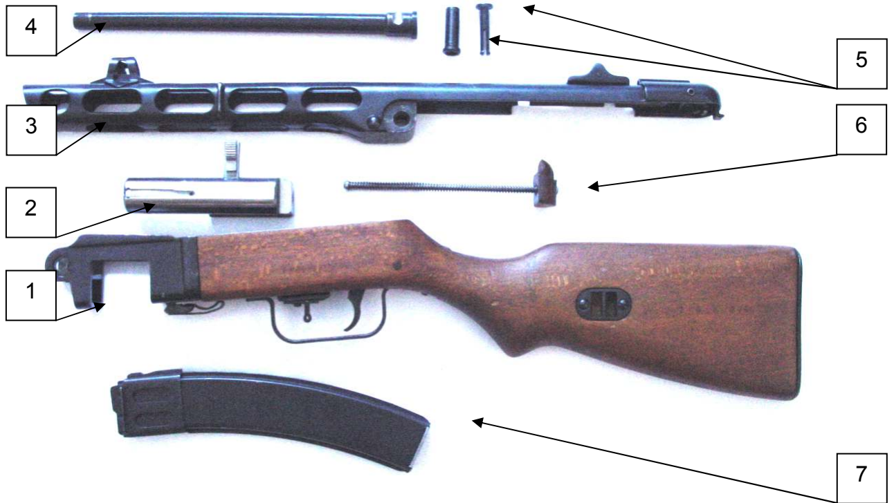
Rys. 6. Widok istotnych części broni 7,62 mm PPSz wz.41: 1 –dolny zsp. komory zamkowej; 2 –zamek; 3 –górný zsp. komory zamkowej; 4 –lufa oraz widok pozostałych części broni częściowo rozłożonej, z odłączoną lufą; 5 –kołek rozprężny i oś główna; 6 –zsp. sprężyny powrotnej; 7 -magazynek
