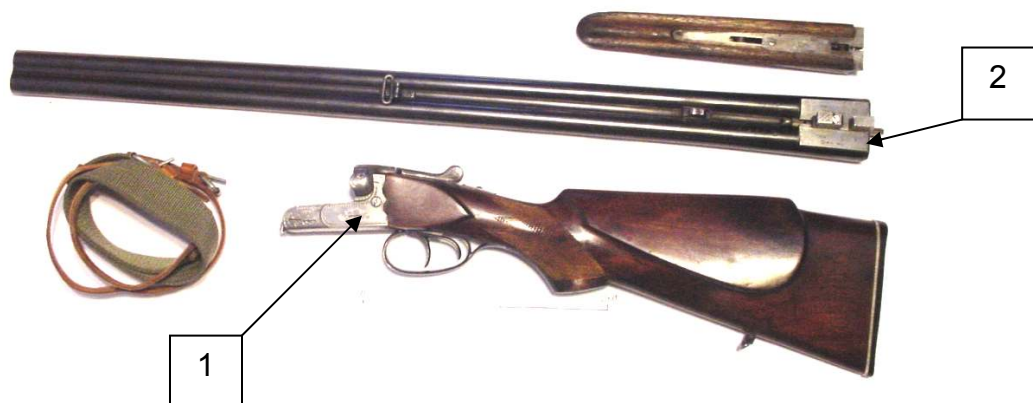
Rys. 5. Widok istotnych części broni myśliwskiej śrutowej: 1 -baskila; 2 -lufy
