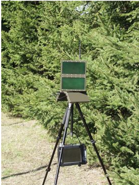
Rys. 2 Radar wykrywająco-ostrzegawczy RWO-1.
