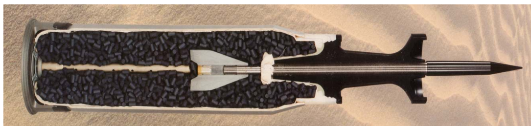
Rys. 4. Przekrój naboju typu APFSDS z sabotem siodłowym
