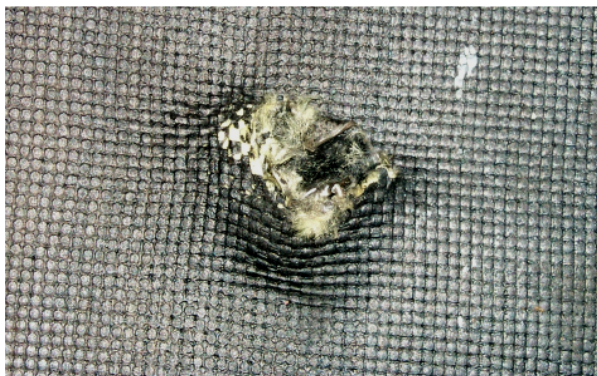
Rys.7. Frontowa strona laminatu N3. Widoczny wbity odłamek granatu.
