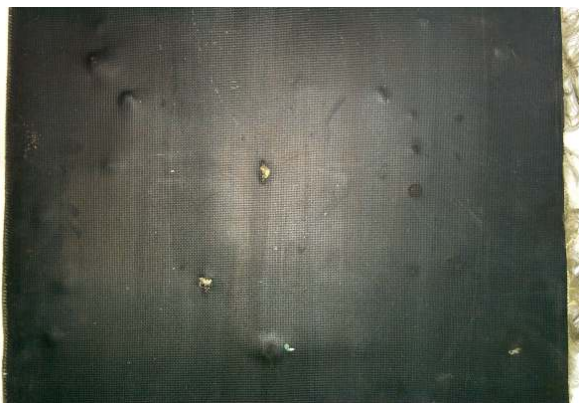
Rys.10. Tylna strona pierwszego laminatu w układzie z 2 laminatami. Laminat przebiły nieliczne odłamki, które zostały zatrzymane w drugim laminacie.
