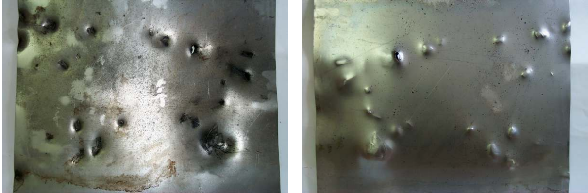
Rys.8. Frontowa i tylna strona blachy karoseryjnej 1,5mm.
