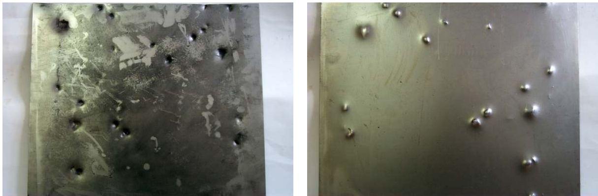
Rys.9. Frontowa i tylna strona blachy w układzie z 1 laminatem.
