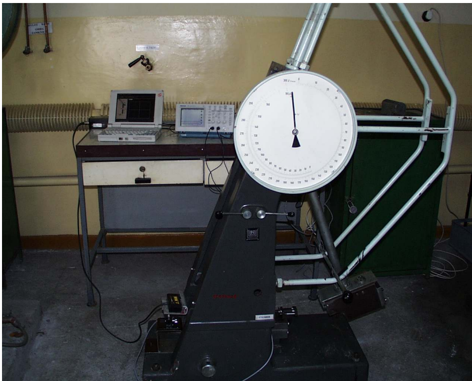
Fot. 2. Stanowisko do badań dynamicznego ściskania na bazie młota Charpy'ego
