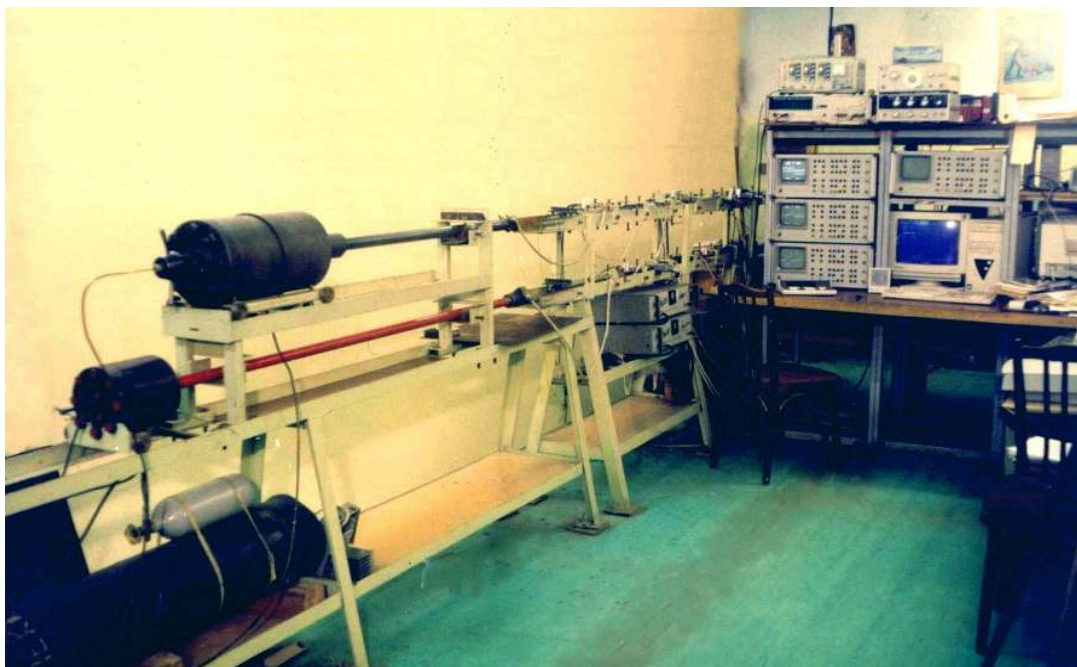
Fot. 3. Stanowisko badawcze – dzielone pręty Hopkinsona na ściskanie o średnicy prętów pomiarowych 10 mm (dolne urządzenie) i 20 mm (górne urządzenie). Na fotografii, po lewej stronie widoczne są wyrzutnie pneumatyczne wraz z lufami, zaś po prawej stronie układ do rejestracji i obróbki elektronicznych sygnałów otrzymanych z pomiarów
