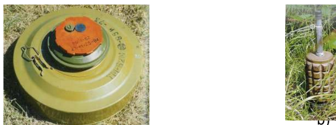
Rys.1. Miny z zapalnikami kontaktowymi: a) TM-62M z zapalnikiem MWCz-62; b) POMZ-2M z zapalnikiem MUW-2.
