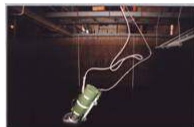
Fot. 3 Mina MMD-2 w moment wodowania
