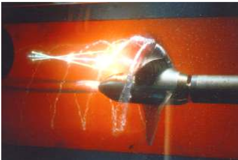
Rys. 2. Powstawanie kawitacji laminarnej na obracającej się śrubie napędowej (źródło: S. A. Kinnas)
