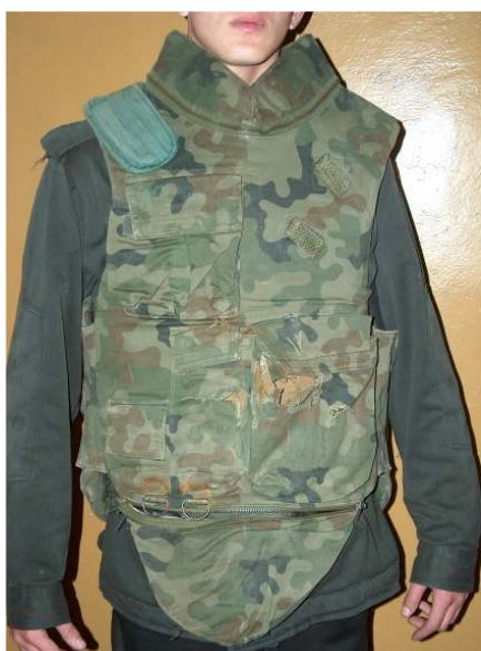
Rys. 15. Uszkodzone poszycie kamizelki OCHRA z 1993 r.
