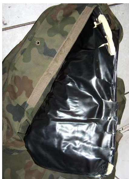
Rys. 16. Uszkodzony pokrowiec wkładu balistycznego kamizelki KLV z 1999 r.
