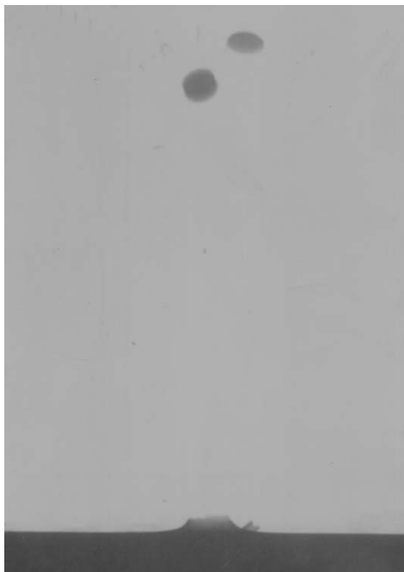
Rys. 14. Zdjęcie rentgenowskie układu z dwóch blach karoseryjnych dla warunków eksperymentu: m_{\text{TNT}} = 50 g, m = 6 g, \Phi = 12 mm. Pocisk przebija obie blachy, ale jest rejestrowany w kadrze. Drugi pocisk to wycięty fragment blachy (korek)
