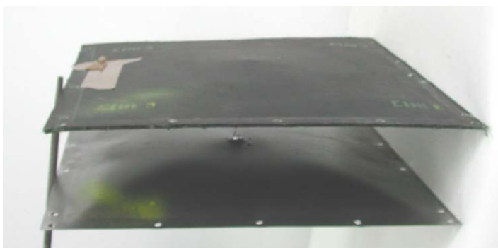
Rys. 6. Zdjęcie blachy karoseryjnej oraz LIM1 po wyjęciu z układu badawczego. Warunki eksperymentu: m_{\text{TNT}} = 50 \text{ g} , m = 6 \text{ g} , \Phi = 10 \text{ mm} . Pocisk zatrzymany przez LIM1.
