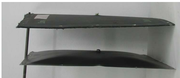
Rys. 8. Zdjęcie układu blachy karoseryjnej oraz laminatu LIM1 po wyjęciu z układu badawczego. Warunki eksperymentu: m_{\text{TNT}} = 50 \text{ g} , m = 6 \text{ g} , \Phi = 10 \text{ mm} . Pocisk przebija LIM1.
