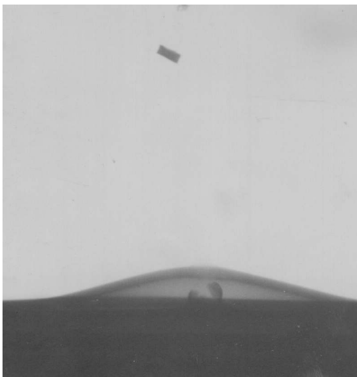
Rys. 7. Zdjęcie rentgenowskie układu blacha karoseryjna – LIM1 dla warunków eksperymentu: m_{\text{TNT}} = 50 \text{ g} , m = 3 \text{ g} , \Phi = 10 \text{ mm} . Pocisk przebija LIM1, ale jest zarejestrowany w kadrze.
