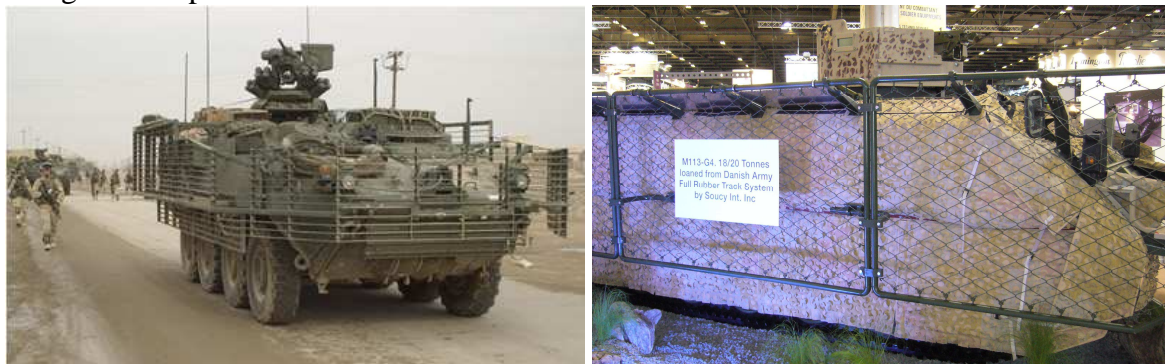
Fot. 1. Osłona prętowa wozu bojowego Stryker oraz przykład osłony siatkowej Opracowanie odpowiednio skutecznej konstrukcji osłony biernej (siatkowej lub
