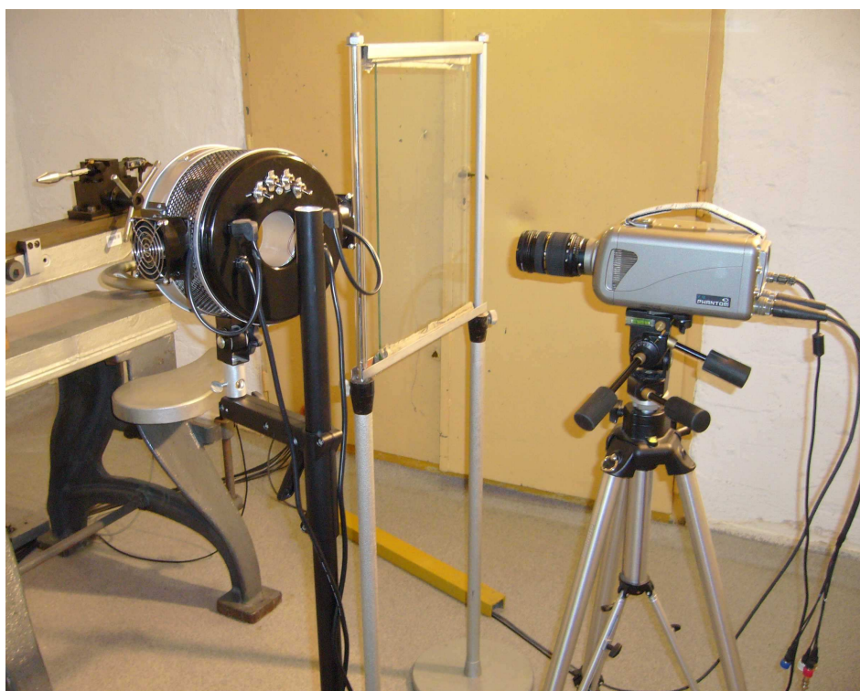
Fot. 5. Elementy stanowiska do rejestracji ruchu modelu pocisku RPG: układ miotający na statywie (z lewej) oraz kamera Phantom v12 (z prawej)
