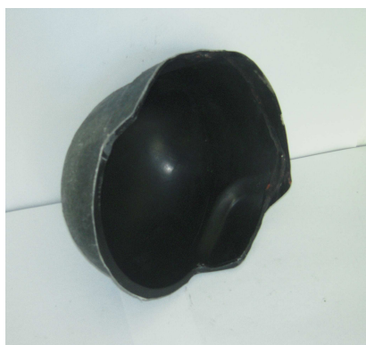
Rys. 5. Laminowana wypraska odwzorowująca wewnętrzny kształt czerepu hełmu modelowego.
