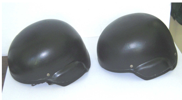
Rys. 1. Modele hełmu z czerepem wykonanym metodą drukowania.
