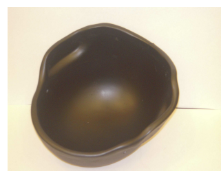
Rys. 8. Modelowy czerep hełmu z opaską krawędziową do badań użytkowych wykonany za pomocą narzędzi przygotowanych na bazie wydruków 3D.
