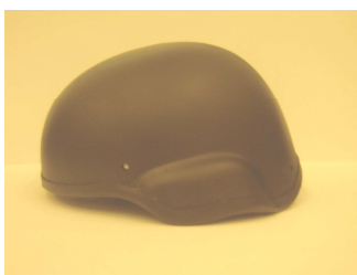
Rys. 8. Modelowy czerep hełmu z opaską krawędziową do badań użytkowych wykonany za pomocą narzędzi przygotowanych na bazie wydruków 3D.
