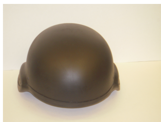
Rys. 8. Modelowy czerep hełmu z opaską krawędziową do badań użytkowych wykonany za pomocą narzędzi przygotowanych na bazie wydruków 3D.
