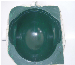
Rys. 6. Forma z laminatu poliestrowo szklanego do wykonania zewnętrznej kształtki czerepu.
