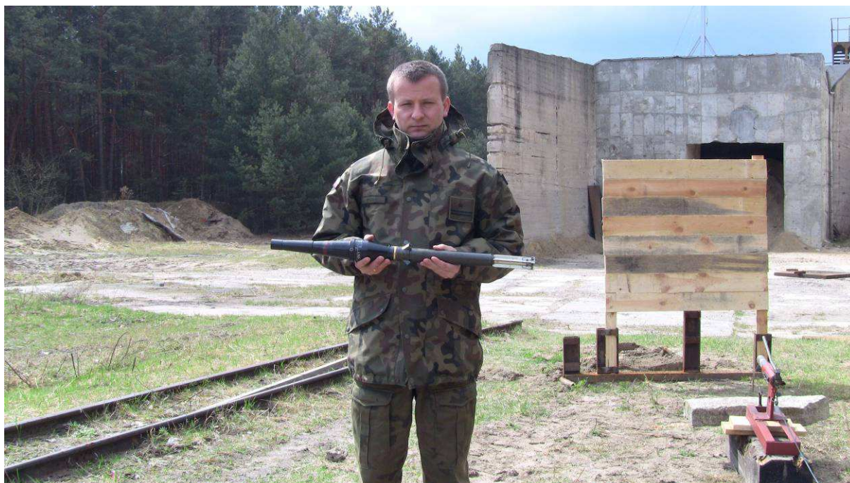
Fot. 1. Widok stanowiska do badań dolnej granicy uzbrajania zapalnika DCR-2. Kierownik badania mjr dr inż. Rafał Bazela z pociskiem PG-76 z zapalnikiem DCR-2 gotowym do załadowania. W dalszej perspektywie wyrzutnia balistyczna, tarcza z desek sosnowych, kulochwyt
