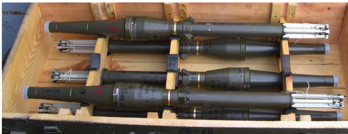
Fot. 7 Granaty PG-76 z zapalnikiem DCR-2 przygotowanie do badań strzelaniem.
