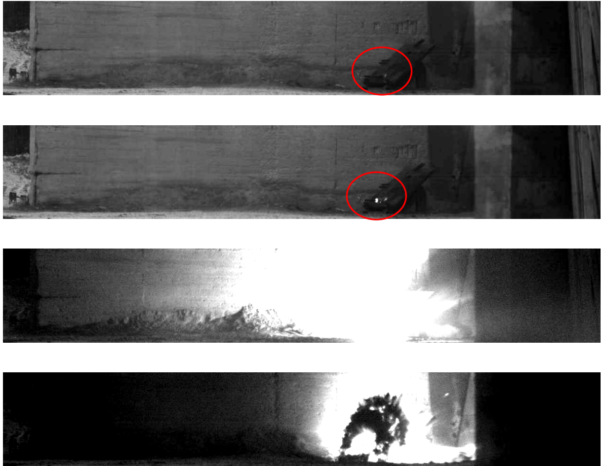
Fot. 9. Sekwencja zdjęć z kamery Phantom V710 podczas badania przebicia płyt pancernych.
