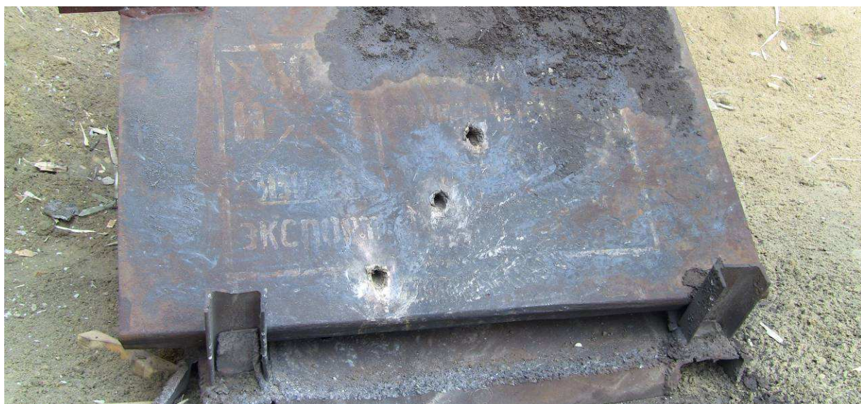
Fot. 10. Płyta pancerna po trafieniach pociskami PG-76.
