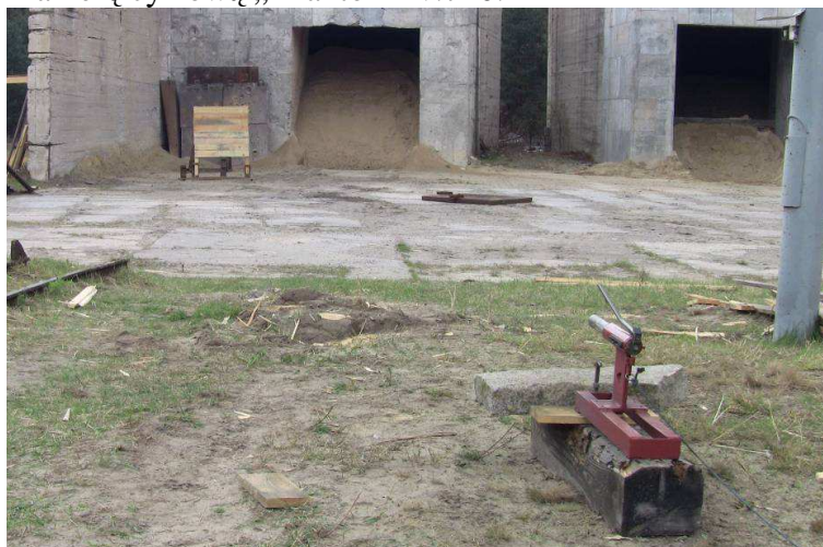
Fot. 5 Widok stanowiska do badań górnej granicy uzbrajania zapalnika DCR-2
