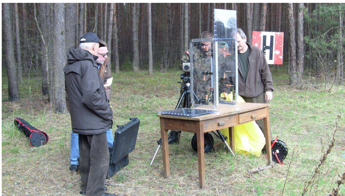
Fot. 2 Stanowisko z kamerą do zdjęć szybkich podczas przygotowania do rejestracji strzałów
