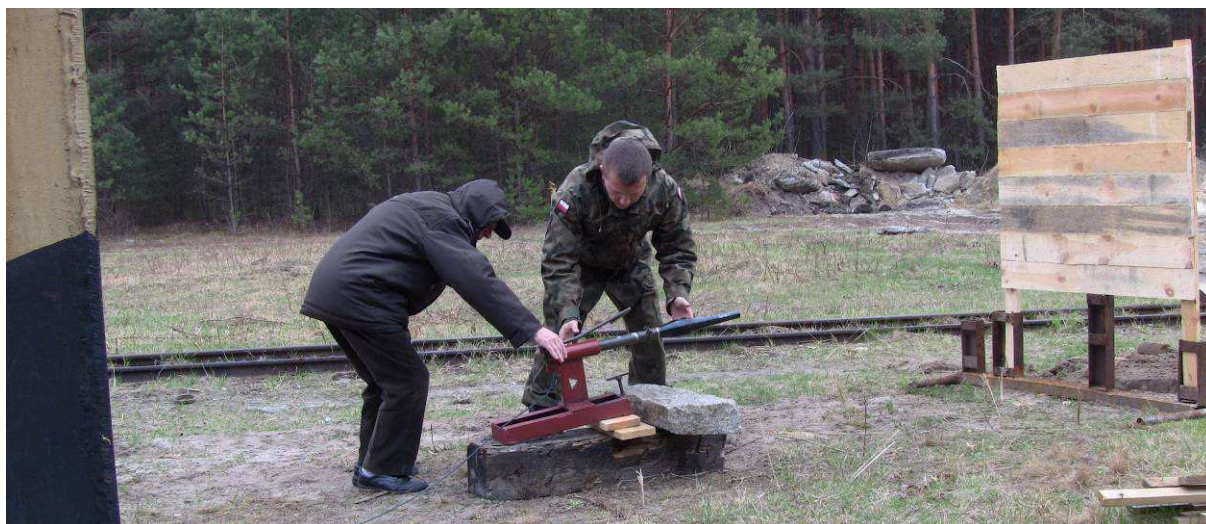
Fot. 3 Załadowanie pocisku PG-76 z zapalnikiem DCR-2 do wyrzutni balistycznej.
