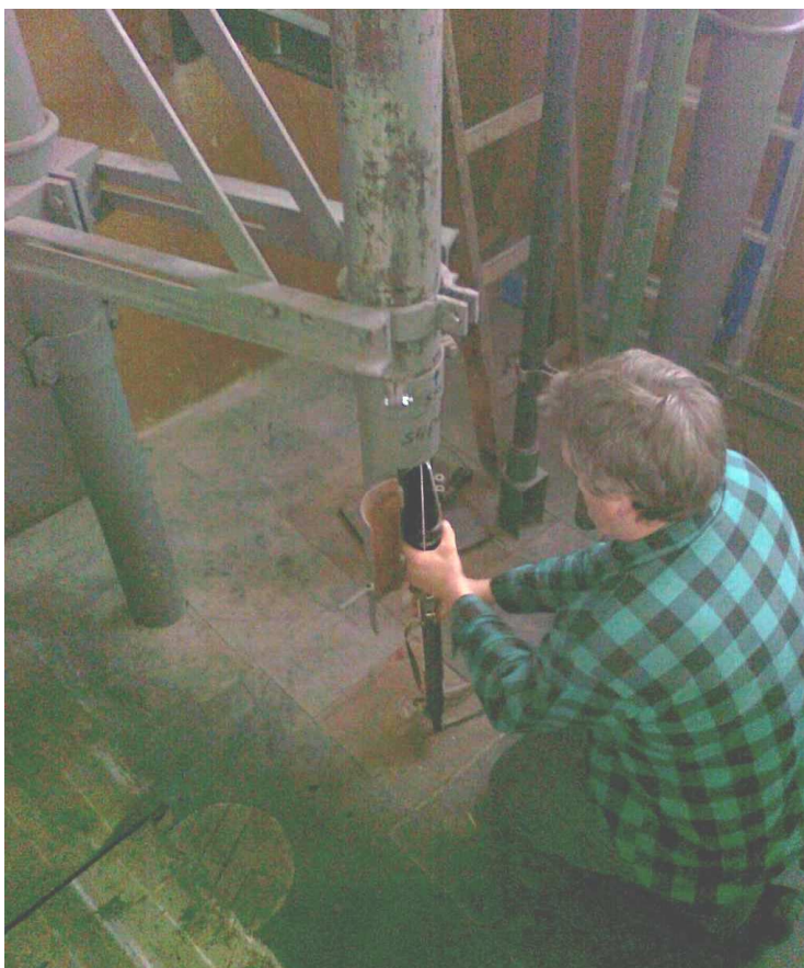
Fot. 1. Widok stanowiska do badań bezpieczeństwa zapalnika DCR-2 przy upadku z wysokości 3 m.
