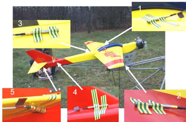
Rys. 4. Rozmieszczenie czujników pomiarowych na samolocie
