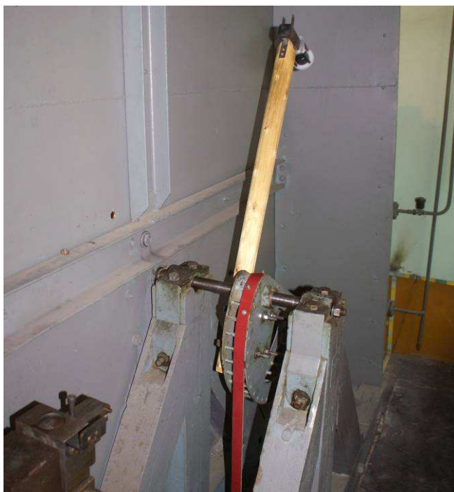
Fot. 9 Zestaw specjalny zapalnika DCR-2 wg sch.5 na stanowisku badawczym
