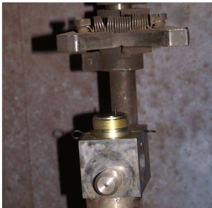
Fot. 3 Zestaw specjalny zapalnika DCR-2 wg sch. 4 na stanowisku badawczym
