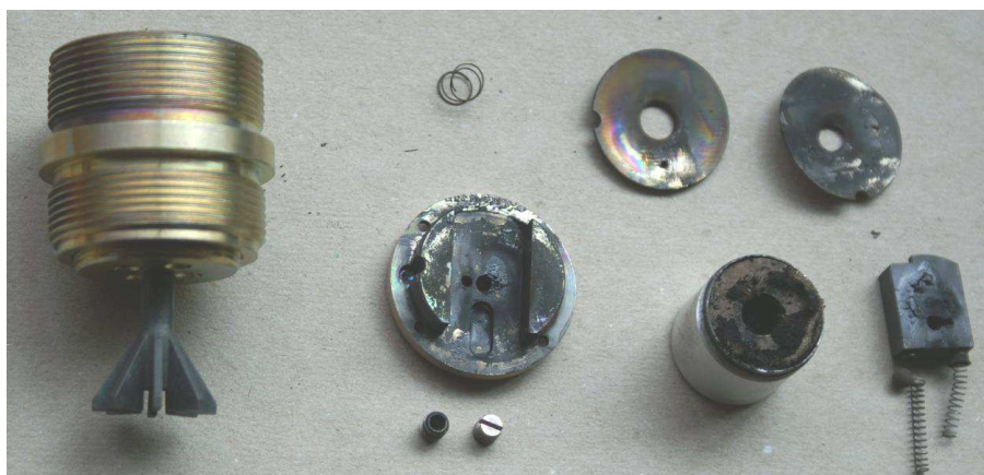
Fot. 4 Zdemontowany zestaw specjalny zapalnika DCR-2 wg sch. 4 po przeprowadzeniu badania
