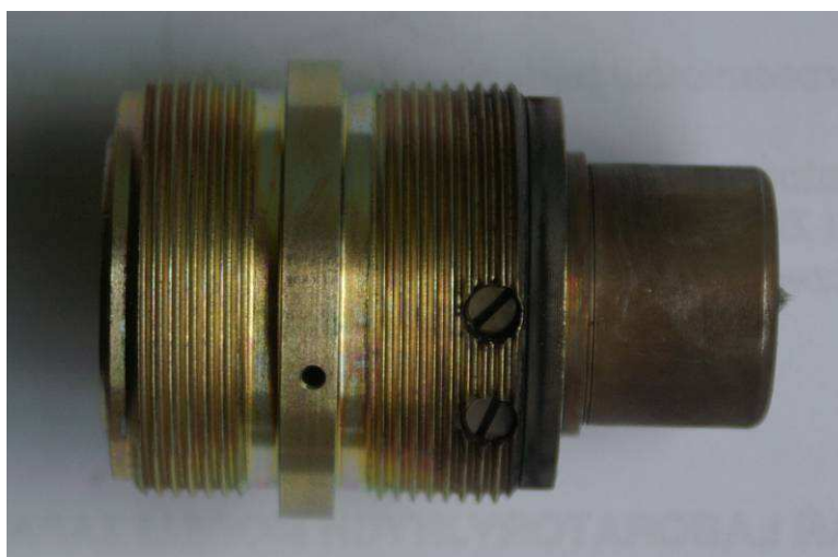
Fot. 10 Zestaw specjalny zapalnika DCR-2 wg sch.5 po badaniu
