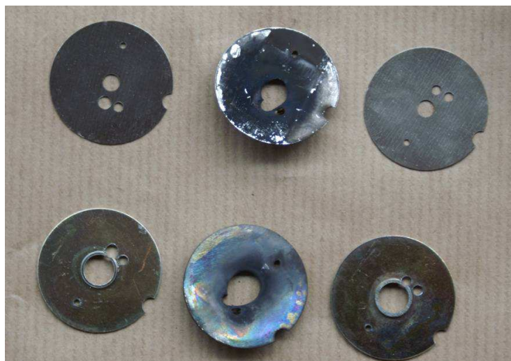
Fot. 8 Od lewej: płytki 7 (dół) i 8 (górze) po zwiększeniu średnicy otworu iglicy; te same płytki po demontażu z badanego zapalnika (środek) i płytki w postaci przed zmianą (z prawej)
