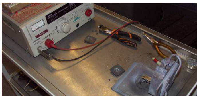
Fot. 1 Stanowisko do sprawdzania spłonek JED: zasilacz wytwarzający impulsy wysokonapięciowe i uchwyt spłonki (wyjęty z komory)
