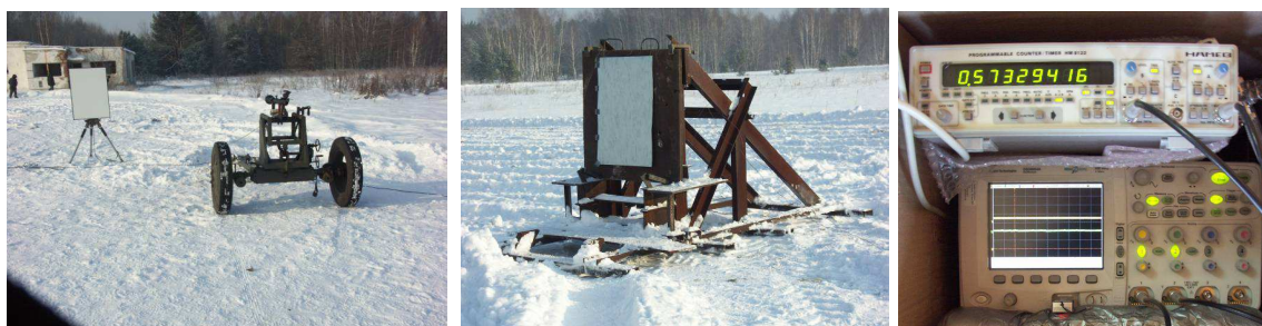
Fot. 4 Stanowisko do badań dynamicznej, od lewej: układ miotający i antena radaru, tarcza z czujnikami zwarciovymi, aparatura pomiarowa
