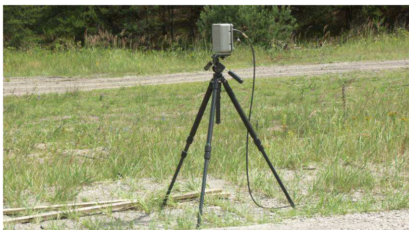
Fot.9. Radarowy zestaw balistyczny do pomiaru prędkości pocisków SL 520P.
