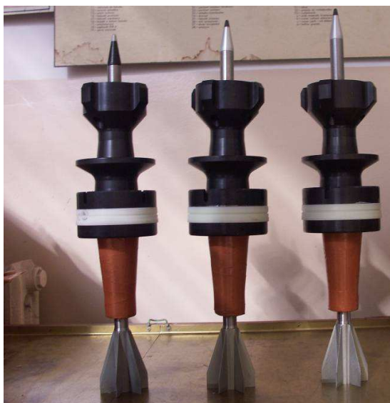
Fot. 3. 125 mm pociski podkalibrowe z penetratorami segmentowymi w wariantach (od lewej) podstawowym W2, A (penetrator z odległością 2 cm pomiędzy segmentami), B (penetrator z odległością 4 cm pomiędzy segmentami).
