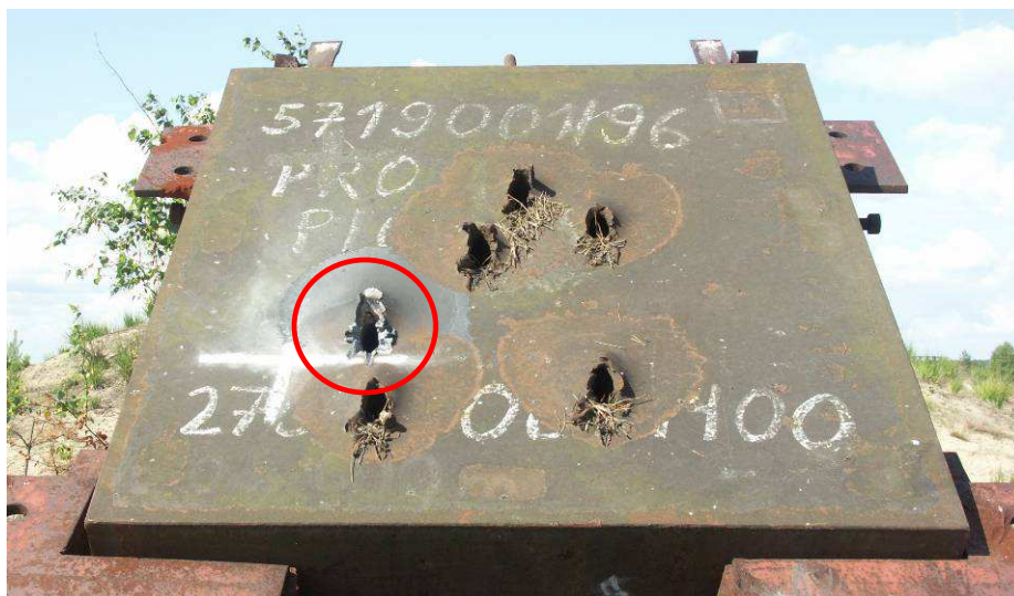
Fot.10. Płyta pancerna z wyszczególnioną przestrzeliną ze strzału nr 4 (pierwszego do płyty) i widocznymi pięcioma przestrzelinami z poprzednich badań.
