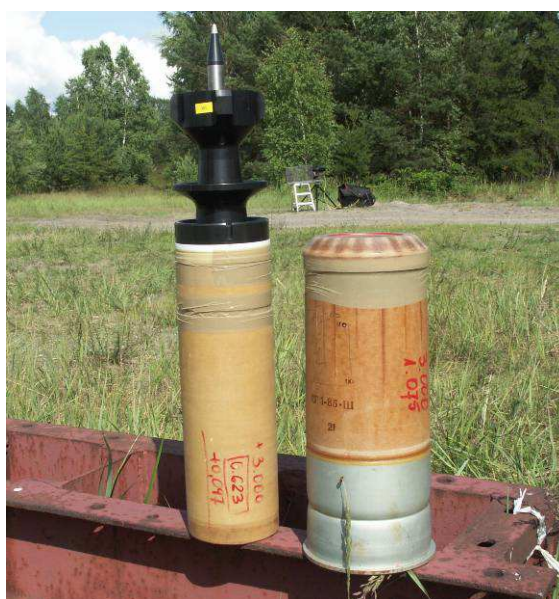
Fot. 6. 125 mm nabój z pociskiem podkalibrowym APFSDS-T z penetratorem segmentowym W2 przygotowany do załadowania do armaty.
