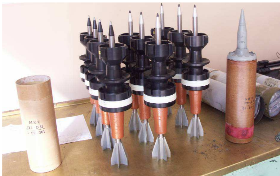
Fot. 4. 125 mm pociski podkalibrowe z penetratorami segmentowymi ładunki miotające przygotowane do elaboracji.
