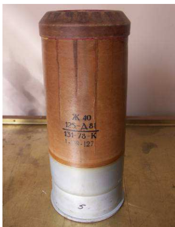
Fot. 5. Ładunek zasadniczy Ż-40 przygotowany do elaboracji naważki ładunku miotającego
