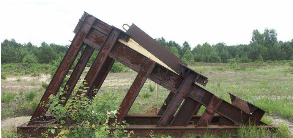
Fot.8. Płyta pancerna RHA o grubości 275 mm ustawiona pod kątem 52° od normalnej w odległości 150 m od stanowiska ogniowego.
