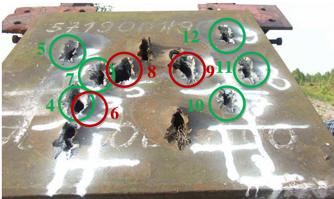
Fot.11. Płyta pancerna z przestrzelinami dla strzałów 4÷12 i widocznymi pięcioma przestrzelinami z poprzednich badań. Kolor zielony oznacza przestrzeliny prawidłowe, kolor czerwony-przestrzeliny w poprzednich kraterach.
