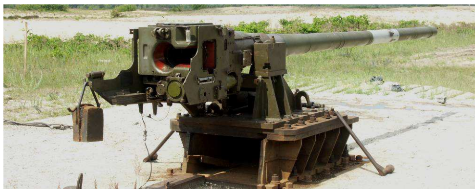
Fot.7. 125 mm armata balistyczna 2A46 zamontowana na stendzie.
