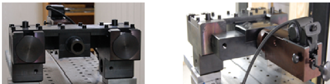
Rys. 8 Opracowane działko pirotechniczne w trakcie prób laboratoryjnych.
