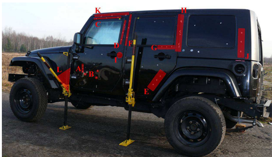
Rys. 1. Widok lewego boku pojazdu z zaznaczonymi strefami ostrzału powierzchni potencjalnie osłabionych (PPO)
