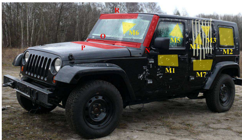
Rys. 2. Widok lewego boku i przodu pojazdu z zaznaczonymi strefami ostrzału PPO - kolor czerwony, oraz powierzchnie ostrzału metodą multihit - kolor żółty
