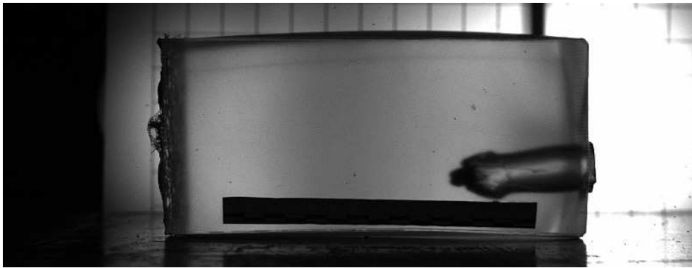
Fot.15. 9 mm pocisk JHP penetrujący 20% blok żelatynowy – 400 \mu s po uderzeniu w blok, widoczny zaburzony kanał rany postrzałowej
