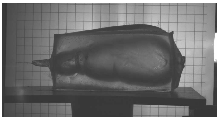
Fot.24. 9 mm pocisk JHP penetrujący blok żelu parafinowego – 5200\ \mu\text{s} po uderzeniu w blok
