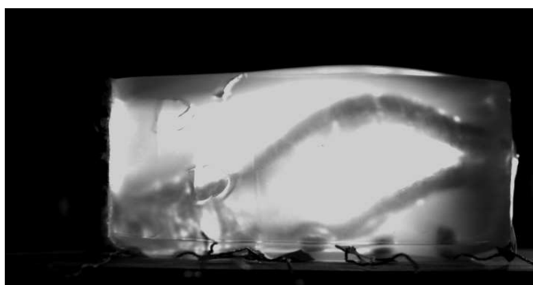
Fot.32. Penetracja 20% nieosłoniętego bloku żelatynowego przez pocisk kalibru 5,7 mm – 2 400 \mu s po uderzeniu w blok
