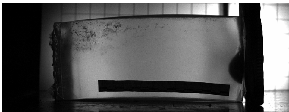
Fot.19. 9 mm pocisk FMJ penetrujący 20% osłonięty blok żelatynowy – 409 \mu s po uderzeniu w blok
