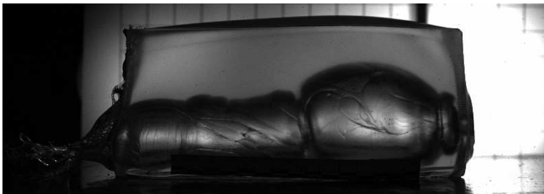
Fot.17. 9 mm pocisk JHP penetrujący 20% blok żelatynowy – 2300 \mu s po uderzeniu w blok
