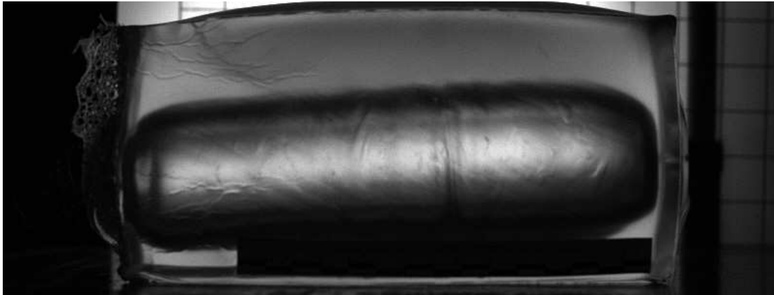
Fot.12. 9 mm pocisk FMJ penetrujący 20% blok żelatynowy – 2500 \mu s po uderzeniu w blok
