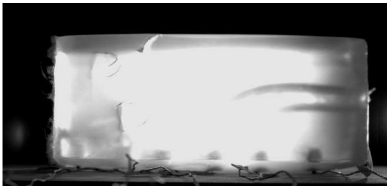
Fot.30. Penetracja 20% nieosłoniętego bloku żelatynowego przez pocisk kalibru 5,7 mm – 200 \mu s po uderzeniu w blok
