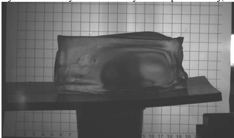
Fot.27. 9 mm pocisk JHP penetrujący blok żelu parafinowego – 10 300 \mu s po uderzeniu w blok,narastanie wtórnego kanału chwilowego wewnątrz rany postrzałowej
