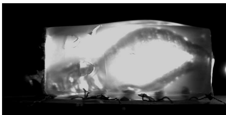
Fot.31. Penetracja 20% nieosłoniętego bloku żelatynowego przez pocisk kalibru 5,7 mm – 2 100 \mu s po uderzeniu w blok
