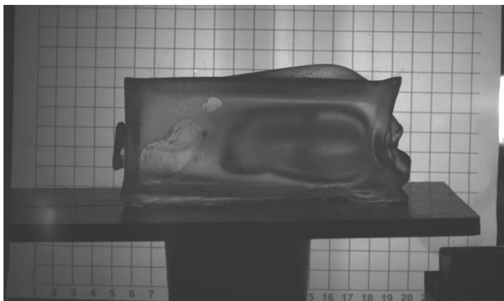
Fot.25. 9 mm pocisk JHP penetrujący blok żelu parafinowego – 8800\ \mu\text{s} po uderzeniu w blok
