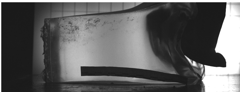
Fot.21. 9 mm pocisk FMJ penetrujący 20% osłonięty blok żelatynowy – 6000 \mu s po uderzeniu w blok
