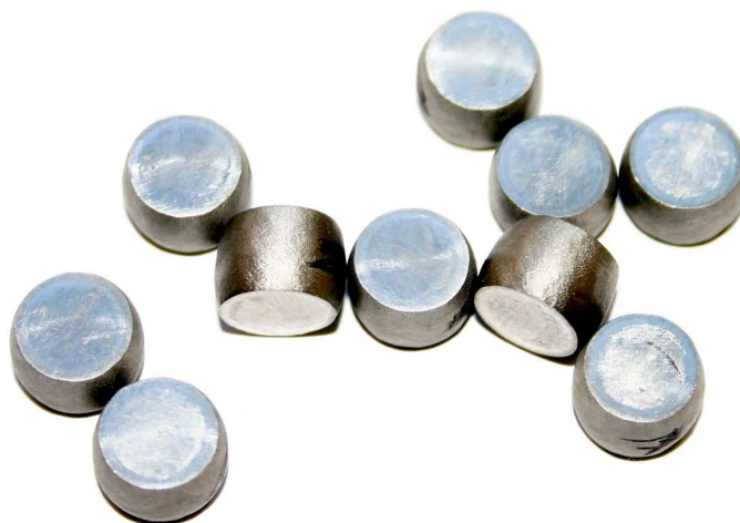
Rys. 4. Widok próbek walcowych po przeprowadzeniu badań statycznych wytrzymałości próbek na ściskanie
