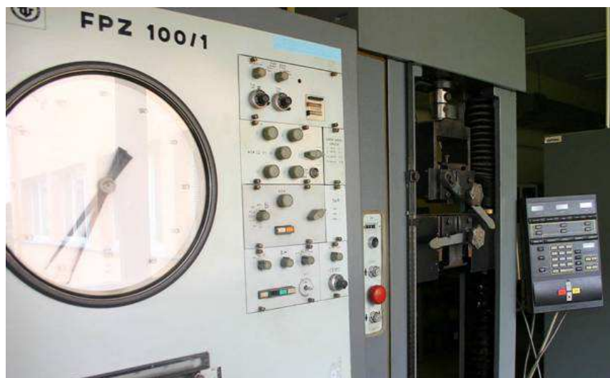
Rys. 1. Maszyna wytrzymałościowa FPZ-100/1 (100 kN) użyte w badaniach statycznych
