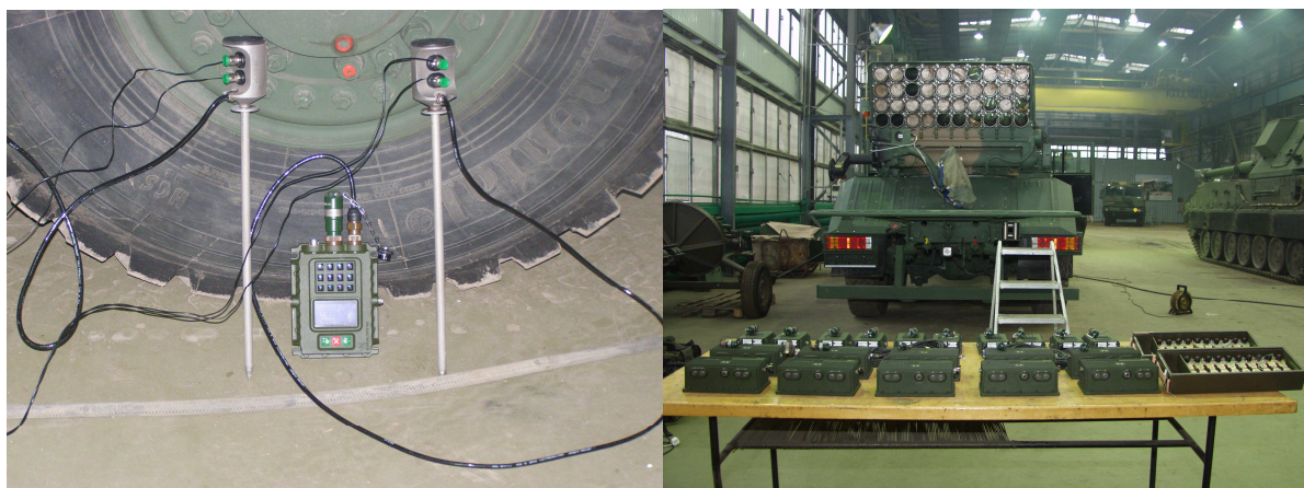
Fot. 7. Odpalarki podczas badań zakładowych w warunkach laboratoryjnych (fot. J. Kijewski)
