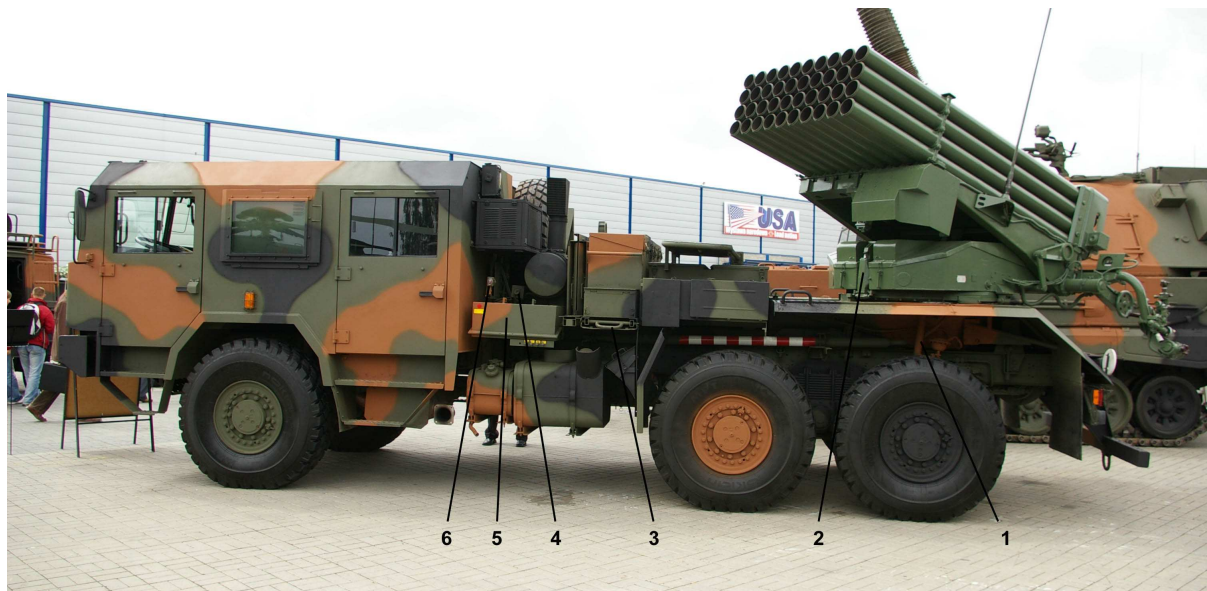
Fot. 2. 122 mm polowa wyrzutnia raketowa WR-40 LANGUSTA (fot. J. Kijewski): 1 – mechanizm wyłączania resorów, 2 – mechanizm ryglowania zespołu podniesieniowego, 3 – drabinka, 4 – gniazdo zasilania zewnętrznego, 5 – skrzynia z akumulatorami, 6 – wyłącznik baterii akumulatorów
