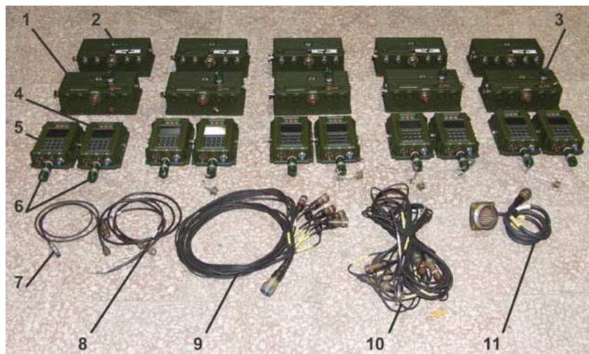
Fot. 6. Pięć kompletów prototypowych odpalarek wykonanych przez WB Electronics (fot. J. Kijewski): 1 – odpalarka, 2 – urządzenie KOMUT-10-TA, 3 – klucz zabezpieczający odpalarki, 4 – zespół odpalania z kabiny ZOK, 5 – zespół odpalania z ukrycia ZOU, 6 – klucz autoryzacji, 7 – przewód komunikacyjny, 8 – przewód zasilający, 9 – przewód linii, 10 – przewód wynośny, 11 – przewód przejściowy
