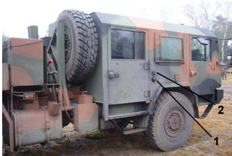
Fot. 3. 122 mm polowa wyrzutnia raketowa WR-40 LANGUSTA – widok z prawej strony na kabinę (fot. J. Kijewski): 1 – tablica liniowa TL-2L, 2 – gniazdo odpalarki wynośnej
