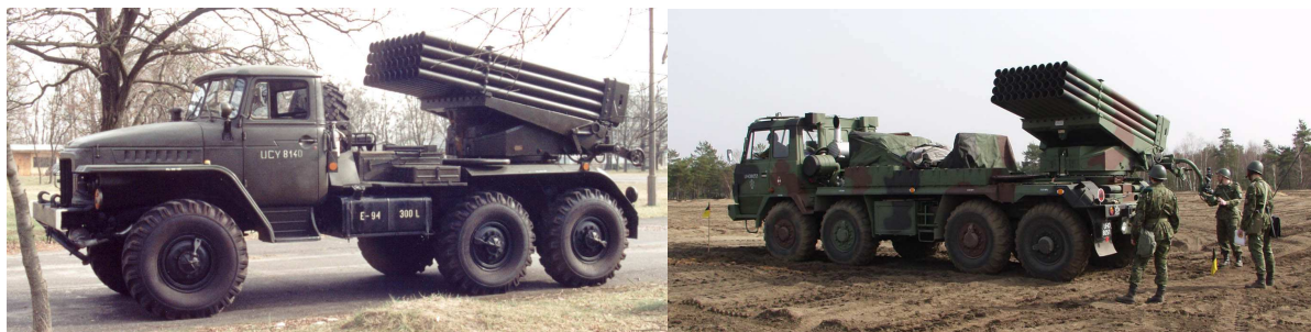
Fot. 1. 122 mm polowa wyrzutnia raketowa BM-21 (z lewej) i RM-70/85 (z prawej strony) (fot. J. Kijewski)
