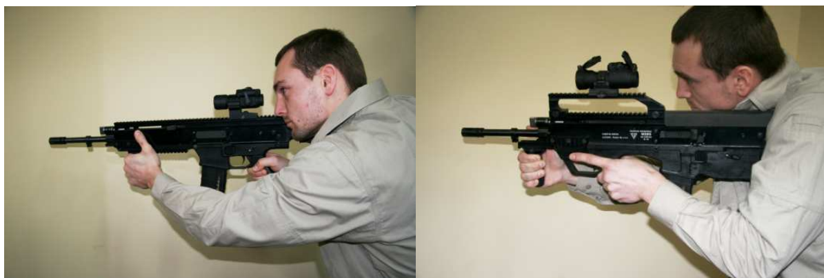
Fot. 1. Demonstratory technologii karabinków podstawowych w układach: kolbowym (z lewej) i bezkolbowym (z prawej) podczas laboratoryjnych testów wymiany magazynka i obsługi broni
