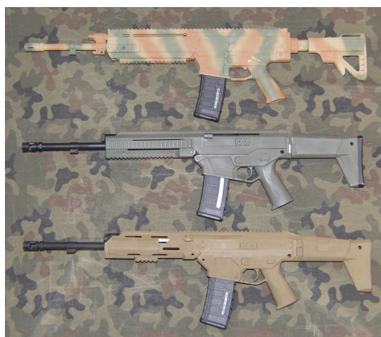
Fot. 7. Makieta karabinka podstawowego w układzie kolbowym, będąca wynikiem drugiej części prac optymalizacyjnych kształtu broni (dół), w porównaniu z wcześniejszymi makietami karabinka
