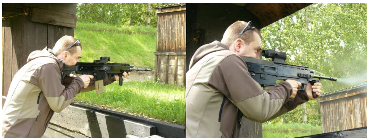
Fot. 2. Strzelanie testujące z demonstratorów technologii karabinków podstawowych w układach: kolbowym (z lewej) i bezkolbowym (z prawej)
