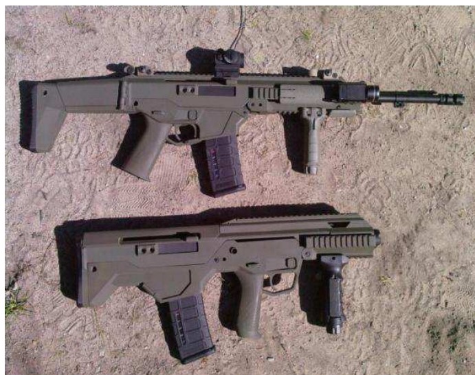
Fot. 6. Makieta karabinka podstawowego w układzie kolbowym (górze) oraz makieta subkarabinka w układzie bezkolbowym (dół) w widoku z prawej strony – wynik pierwszej części prac optymalizacyjnych kształtu broni
