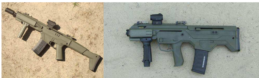
Fot. 5. Makieta karabinka podstawowego w układzie kolbowym (z lewej) oraz makieta subkarabinka w układzie bezkolbowym (z prawej) w widoku z lewej strony – wynik pierwszej części prac optymalizacyjnych kształtu broni
