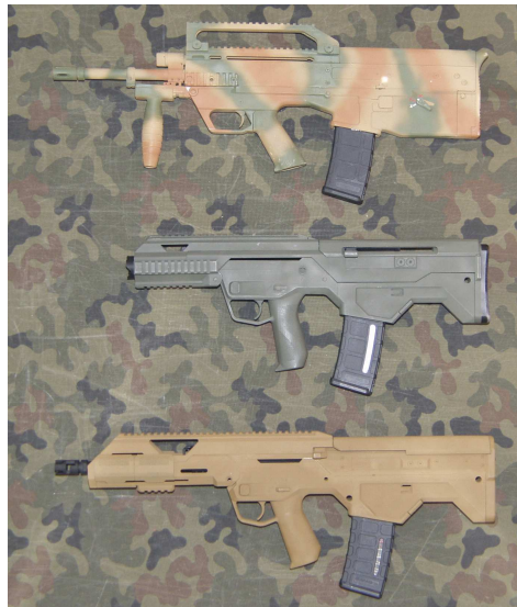
Fot. 8. Makieta karabinka podstawowego w układzie bezkolbowym, będąca wynikiem drugiej części prac optymalizacyjnych kształtu broni (dół), w porównaniu z wcześniejszymi makietami karabinka i subkarabinka (środek)
