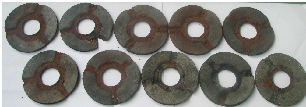
Zdjęcie 4. Zdemontowane podkładki kompensujące 122 mm pocisków raketowych M-21 z śladami korozji rusztu.
