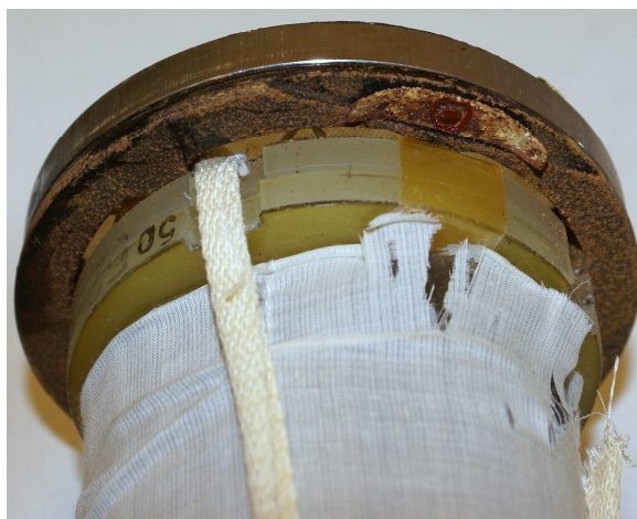
Zdjęcie 11. Korozja elementów metalowych ładunku miotającego OG-9
