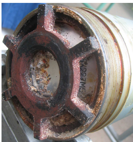
Zdjęcie 5. Ruszt i zapłonnik elektryczny 122 mm pocisku raketowego M-21 przed demontażem. Widoczny skorodowany ruszt oraz perforacja korpusu zapłonika.
