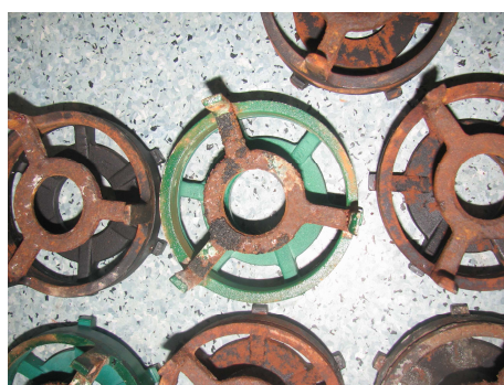
Zdjęcie 2. Korozja na zdejmowanych rusztach 122 mm pocisku rakietowego M-21
