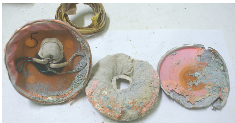
Zdjęcie 7. Zdemontowany zapalnik 9Ch227 122 mm z pocisku raketowego M-21. Widoczny korpus zapalnika zniszczony przez procesy korozyjne. W środku widoczny uszkodzony ładunek zapalający z zawilgoconym prochem czarnym.
