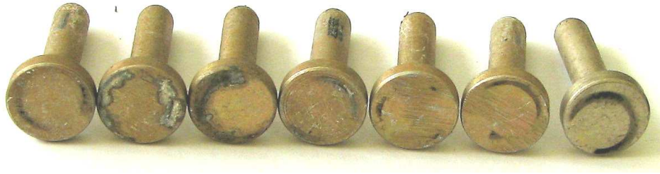
Zdjęcie 8. Korozja na popychaczach w miejscu styku ze sprężyną kolby.
