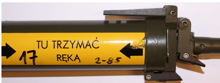
Zdjęcie 10. Korozja ustalacza blokująca podniesienie się celownika do pozycji bojowej
