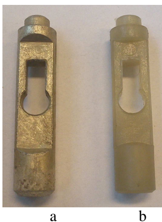
Zdjęcie 14. Spust do RPG-76: a) metalowy z widocznymi ogniskami korozji w dolnej części spustu, b) plastikowy
