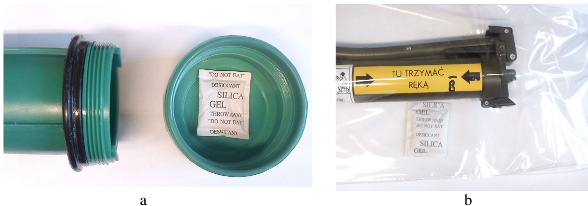
Zdjęcie 15. Przykładowe przedstawienie zastosowania osuszaczy: a) w opakowaniu na ładunek miotający naboju przeciwpancernym OG-9, b) w opakowaniu foliowym w RPG-76
