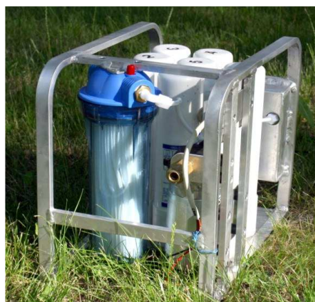
Fot. 2 Zespół pompowo – filtrujący FPW-50
