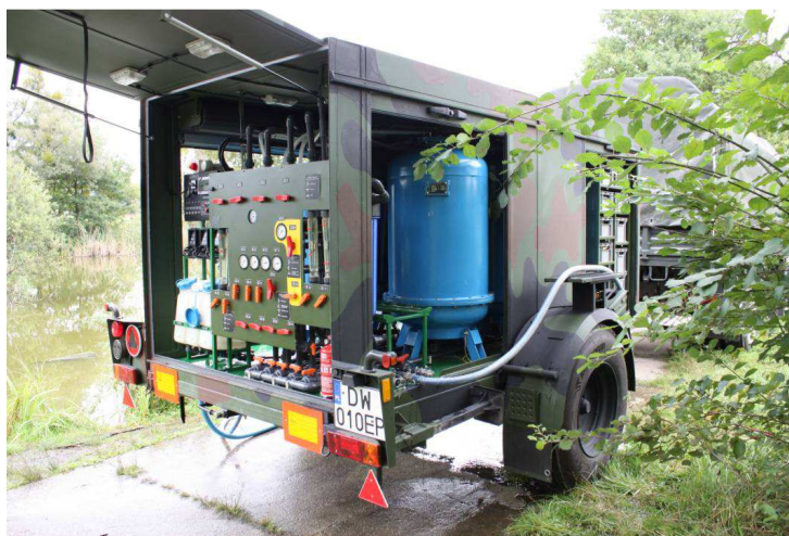
Fot. 8. Filtr uzdatniania wody FPW-2
