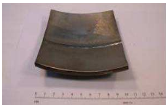
Rys.6. Wycinek zbiornika ze spoiną obwodową.
