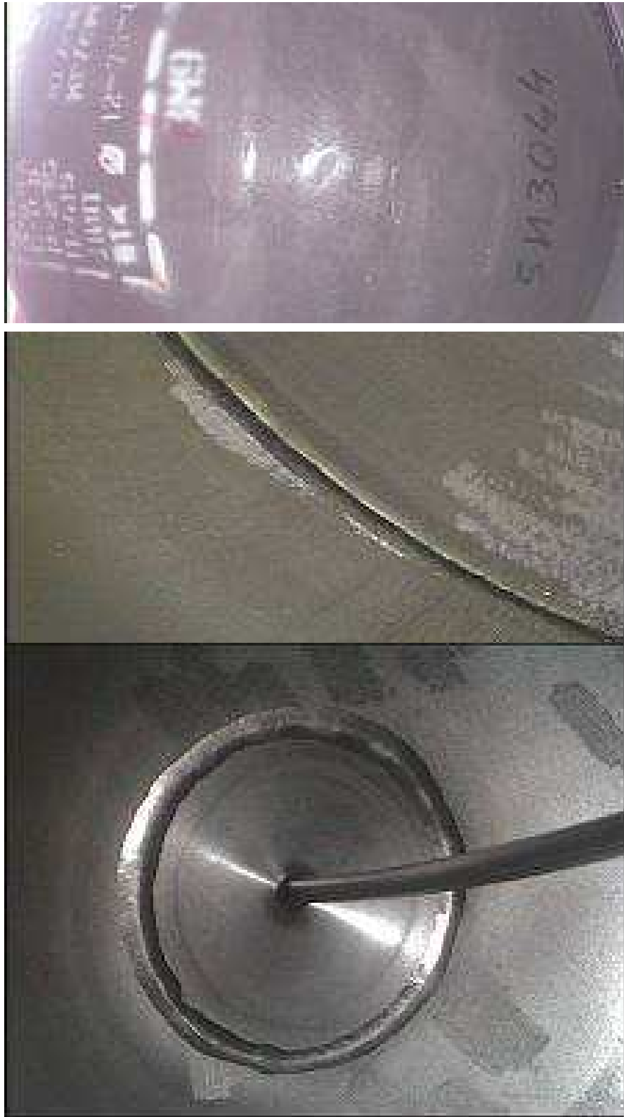
Rys.2. Zbiornik nr 3044, widoczny spaw obwodowy oraz połączenie spawane króćca napełniania, przetop pełny.
