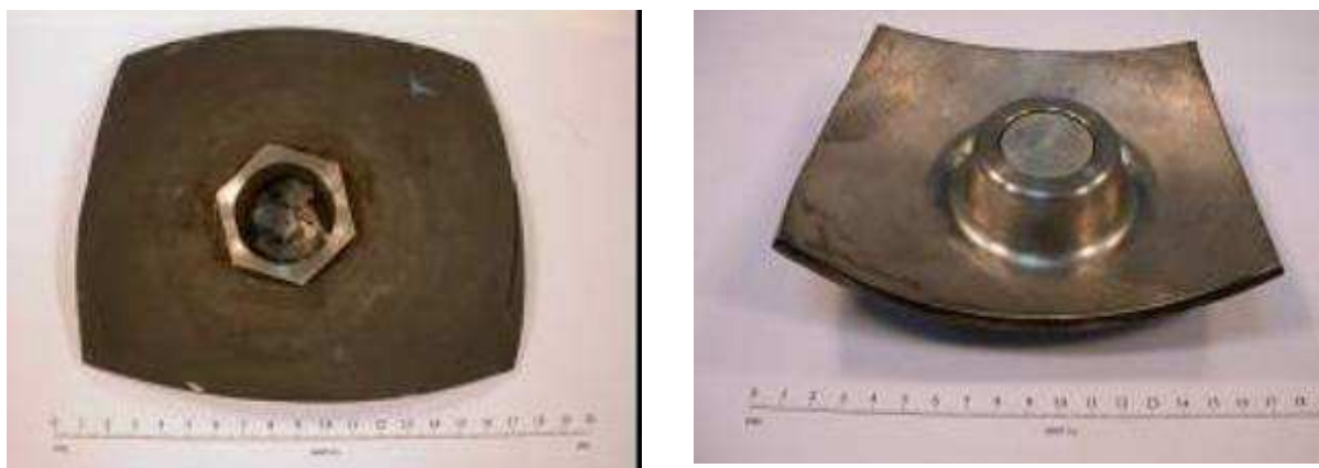
Rys.8. Wycinek zbiornika z korkiem technologicznym.
