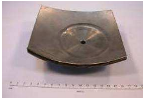
Rys.7. Wycinek zbiornika z króćcem napełniania.
