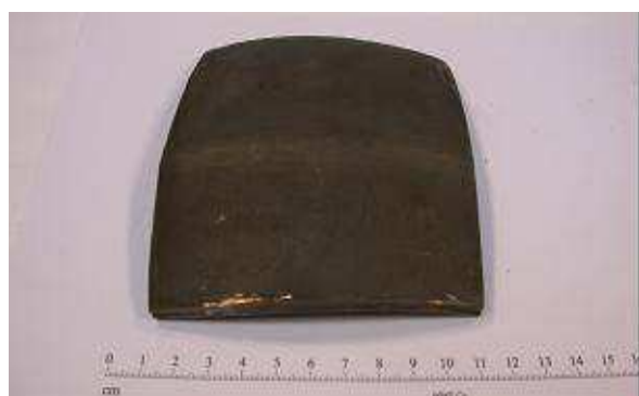
Rys.6. Wycinek zbiornika ze spoiną obwodową.
