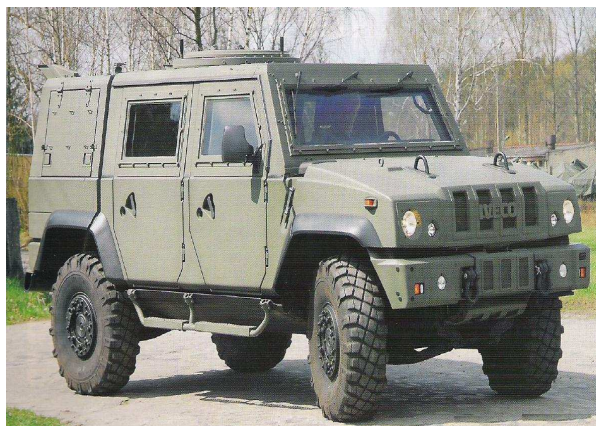
Rys. 7. Proponowany Polsce w ramach konkursu na LOSP pojazd włoski IVECO LMV (Light Multirole Vehicle) M65E19WM. Należy do samochodów minoodpornych patrolowych, wykorzystywane są one w Afganistanie przez Włochy, Belgię, Norwegię, Chorwację. Odnotowano trzy ataki minowe na ten typ pojazdu, w których nie zginął żaden żołnierz.
