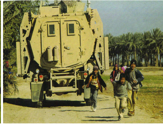
Rys. 9,10. Pojazd minoodporny Caiman wykonany był przez firmę BAE Systems. Konstrukcja pojazdu ma przedział załogowy w postaci kabina – cytadela. Zainstalowana na ramowym podwoziu. Kabina – cytadela, posiada dno z profilem w kształcie litry V, dodatkowo pod podwoziem ramowym jest deflektor o zbliżonym profilu. Caimany pełniły służbę od września 2007r w Iraku. Pojazd Caiman ma niechlubne pierwsze miejsce w liczbie wywrotek – 12 przypadków. Nowe wersje Caiman MTV są przystosowane w pewnym zakresie do terenu w Afganistanie. Nowa wersja MTV zaprezentowana została w lutym 2010r. Na prawym zdjęciu widoczny jest zarys dna pojazdu – minoodporny.
