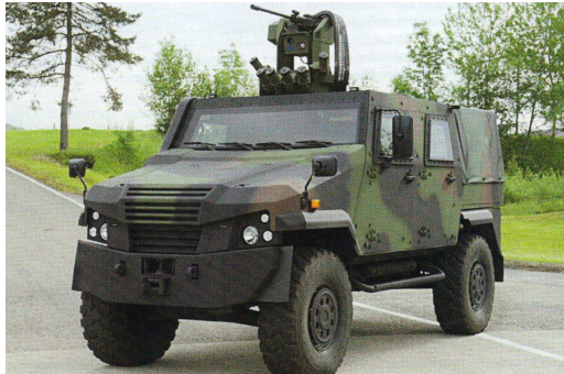
Rys. 22. Firma MOWAG prezentuje pojazdy patrolowe nowej generacji Eagle IV o masie całkowitej - standardowej 7,3 t (3 t masa użyteczna). Niemcy testują ten pojazd poczynając od masy 5,3 t.
