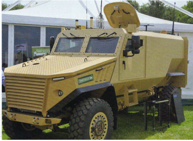
Rys. 21. Kompozytowe nadwozie OCELOTA wykonane zostało przez firmę Formaplex, która jest dostawcą elementów z tworzyw sztucznych. Z uwagi na konstrukcję pojazdu jest to pojazd opancerzony o modułowej budowie. Zasadnicze zespoły napędowe – przeniesienia mocy znajdują się w pancernej „wannie”. W związku z tym pojazd może kontynuować jazdę nawet po utracie jednego z kół.
