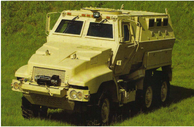
Rys. 9,10. Pojazd minoodporny Caiman wykonany był przez firmę BAE Systems. Konstrukcja pojazdu ma przedział załogowy w postaci kabina – cytadela. Zainstalowana na ramowym podwoziu. Kabina – cytadela, posiada dno z profilem w kształcie litry V, dodatkowo pod podwoziem ramowym jest deflektor o zbliżonym profilu. Caimany pełniły służbę od września 2007r w Iraku. Pojazd Caiman ma niechlubne pierwsze miejsce w liczbie wywrotek – 12 przypadków. Nowe wersje Caiman MTV są przystosowane w pewnym zakresie do terenu w Afganistanie. Nowa wersja MTV zaprezentowana została w lutym 2010r. Na prawym zdjęciu widoczny jest zarys dna pojazdu – minoodporny.
