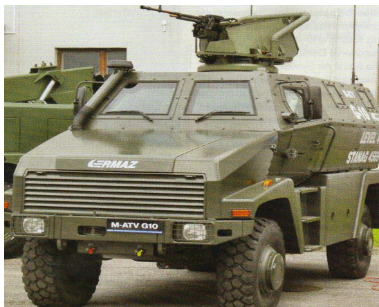
Rys. 26. Prezentowany na wystawie w Kielcach 2010r. demonstrator polskiego M-ATV G10. Masa całkowita 11,5 t. Ochrona balistyczna standardowa na poziomie Level 2 wg STANAG 4569. Z masą całkowitą o 730 kg większą ma poziom ochrony Level 4. Pojazd może być wykonywany o masie w granicach 9 - 12 t (10 miejsc).
