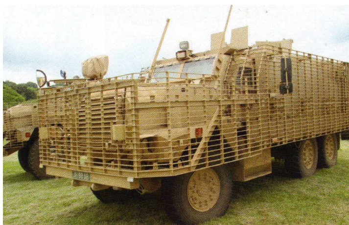
Rys.13. Samochód opancerzony MASTIFF, PPV (Protected Patrol Vehicle) jest brytyjskim wariantem amerykańskiego MRAP, Cougara HE (6x6). Jest silniej opancerzony. Transportuje 10 osób. Ma system radioelektrycznego przeciwdziałania uruchomieniu sygnału do zadziałania ładunku IED lub miny. Konstrukcja V, dna chroni od min i IED równoważnych 7 kg TNT.
