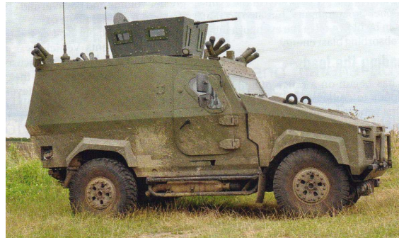
Rys. 23. Zephyr – Land Rovera (4x4) masa całkowita 7,5 t (2 t ładunek użyteczny) ochrona balistyczna Level 3, STANAG 4569, część silnikowa wierzchnia Level 1. Odporność może być różna w zależności od zamówienia.
