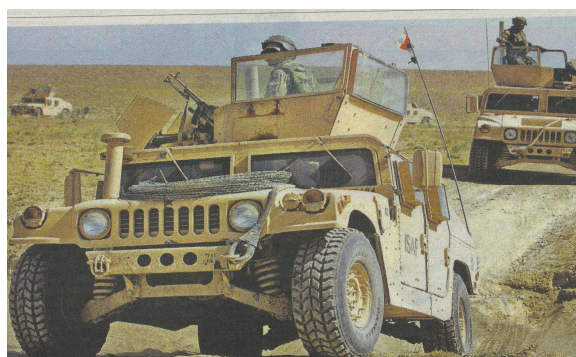
Rys.17,18. Jedna z najczęściej używanych wersji do zadań patrolowych w Afganistanie samochodu HMMWV – M1114. Jest to pojazd wielozadaniowy o masie bojowej 5489 kg. Wyprodukowano ok. 20000 tys. egzemplarzy. Nie spełnił warunku zmniejszenia zagrożenia od IED
