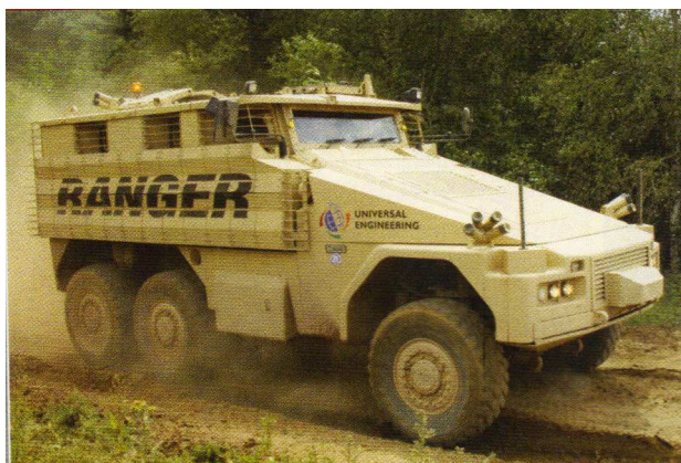
Rys.16. Ranger PPV prezentowany na DVD w 2010r. był jednym z najcięższych masowo pojazdów typu MRAP. Na fotografii wersja 6x6 – nierówne rozstawienie osi pojazdu niedobrze świadczy o terenowych zdolnościach pojazdu.
