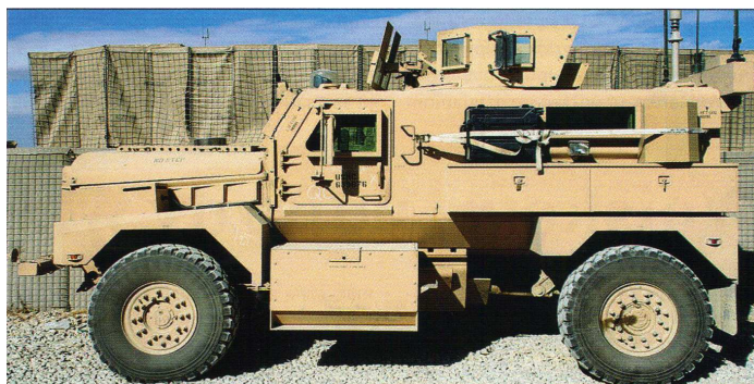
Rys. 12. Ciężki pojazd MRAP – Cougar H eksploatowany przez PKW ma wysoką odporność na działanie min IED (sprawdzona w praktyce szczególnie podczas trwania IV zmiany PKW). Wada pojazdu – wysoko położony środek ciężkości, duże gabaryty.
