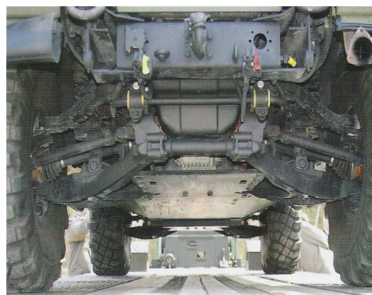
Rys. 8. Spód podwozia pojazdu LMV. Widoczne jest niezależne zawieszenie pojazdu oraz pancerna wana pod kabiną – cytadelą.
