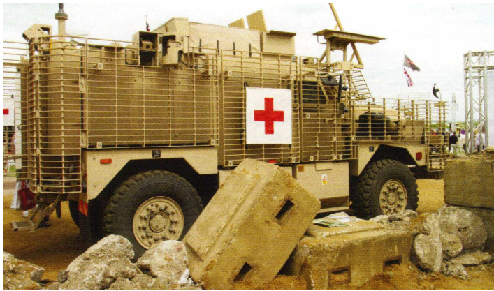
Rys. 14. Wóz ewakuacji medycznej (Battelfield Ambulance) jest jedną z wersji Ridgbacka używanych przez kontyngent brytyjski. Oprócz wyposażenia medycznego ma także wieżyczkę strzelca oraz zagłuszarki ładunków IED.
