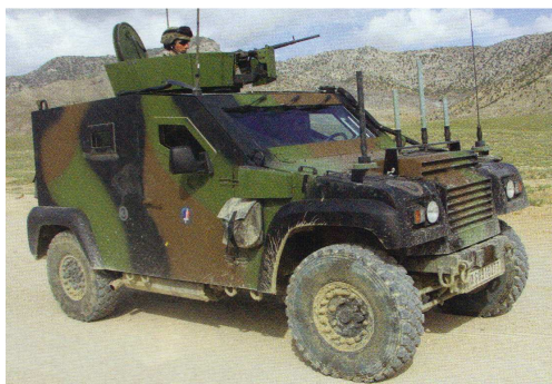
Rys. 24. Francuskie lekkie pojazdy reprezentuje Panhard General Defense PVP, przewidziany do eksploatacji w Afganistanie. Wyposażony w wykrywacz ładunków IED. Masa całkowita 7,6 t.
