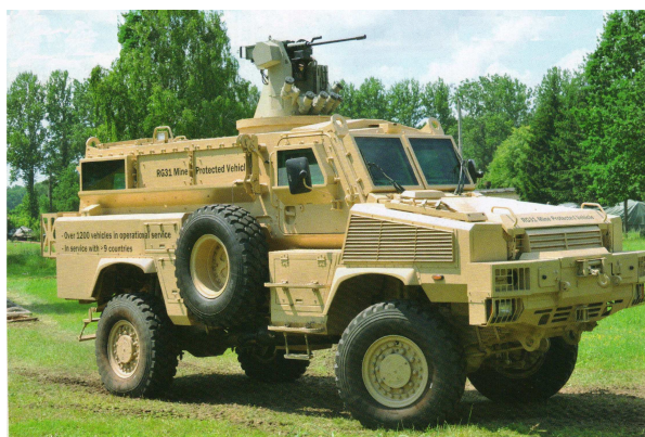
Rys. 20 . Pojazd produkcji BAE Systems RG-31 Mk5E prezentowany w WITPiS - 2010r. Opancerzenie przedziału załogi na poziomie 3 wg STANAG 4569, komora silnika na poziomie 1 STANAG 4569. Ochrona przeciwminowa 4a oraz 3b wg STANAG 4569, co odpowiada eksplozji miny TM-57 ładunek 7 kg pod kadłubem i dwóch TM-57 ładunek 14kg TNT pod dowolnym kołem. W RPA są inne normy na sprawdzanie odporności minowej. Sprawdza się minami TM-57.
