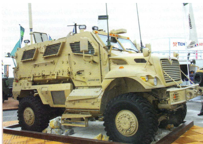
Rys.19. Pojazdy M-ATV – MaxxPro Dash wstąpiły do służby w PKW jesienią 2010r. Są wyposażone w niezależne zawieszenie DXM, które ma na celu lepsze dostosowanie pojazdu do warunków Afganistanu.
