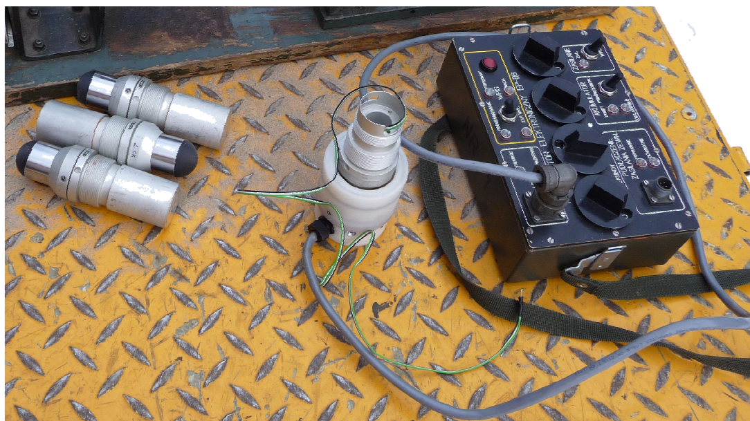
Fot. 4. Zestaw do programowania zapalników zbliżeniowych z modułami radiowymi.
