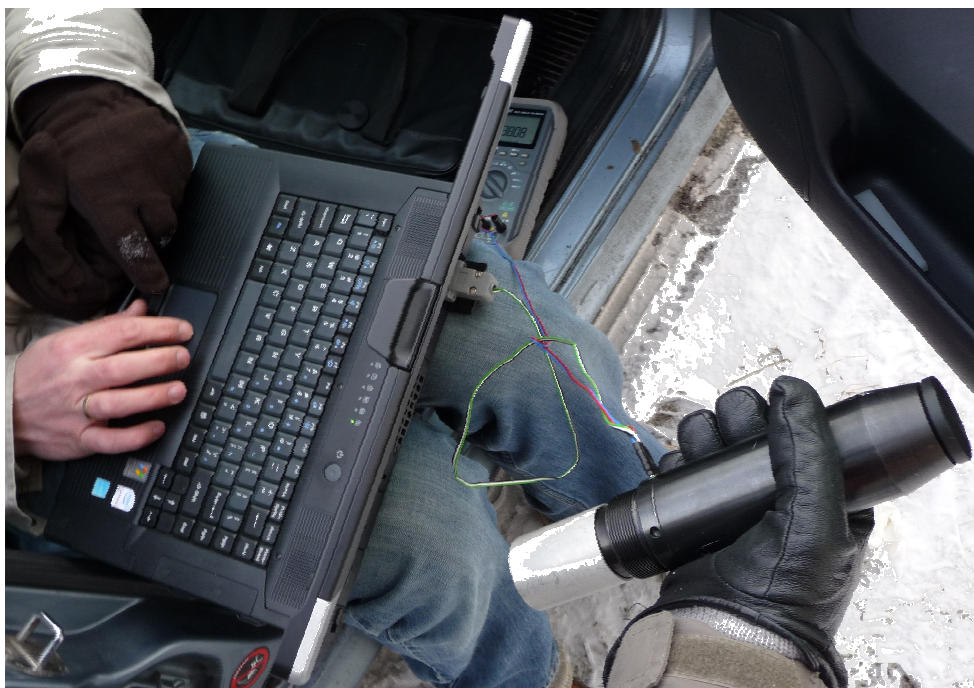
Fot. 5. Programowanie zapalnika zbliżeniowego z modułem laserowym.
