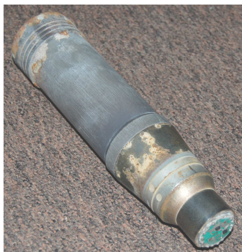
Fot. 7. Zapalnik zbliżeniowy z modulem radiowym po strzelaniu.
