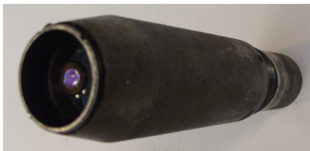
Fot.6. Zapalnik zbliżeniowy z modulem laserowym po strzelaniu.
