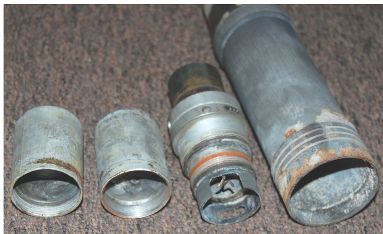
Fot.8. Zapalnik zbliżeniowy z modulem radiowym po strzelaniu - rozłożony.
