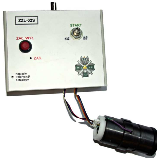
Fot. 3. Moduł optyczny podłączony do testera.
