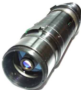
Fot. 4. Zdjęcie laserowego zapalnika zbliżeniowego po laboratoryjnych testach odporności na udar (zapalnik ze zdjętą osłoną korpusu).
