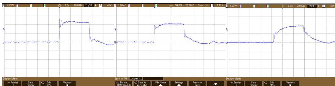
Rys. 3. Wyniki rejestracji wpływu długości połączenia sterownika lasera z diodą laserową na kształt impulsu prądowego lasera (odpowiednio 1cm, 5cm, 20cm).
