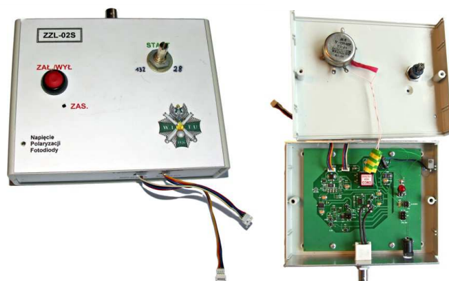
Fot. 2. Urządzenie do testowania i regulacji modułu optycznego zapalnika laserowego.
