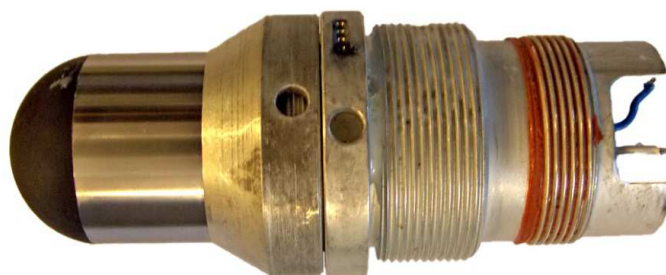
Fot. 5. Zdjęcie finalnie zmontowanego radiowego zapalnika zbliżeniowego (bez zespołu zabezpieczająco-uzbrajającego).
