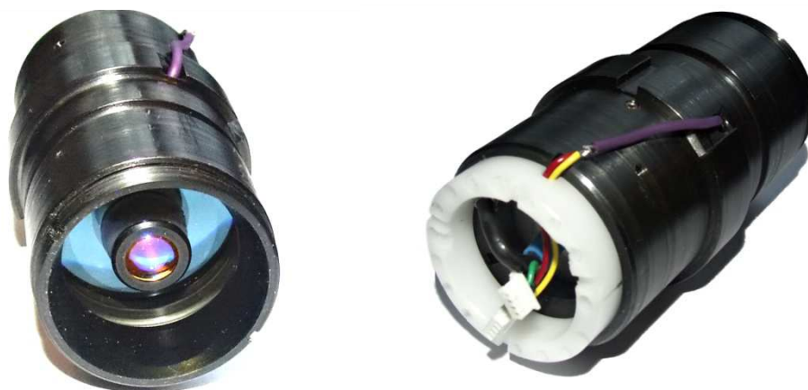
Rys. 4. Zdjęcia jednego z wykonanych modułów optyki dla laserowego zapalnika zbliżeniowego
