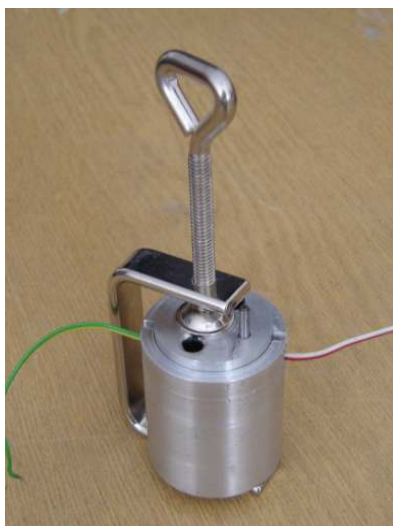
Rys. 8. Widok formy z umieszczonymi układami elektronicznymi - w górnej części widoczne otwory zalewowe
